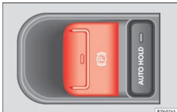
Afb. 200 Deel van de middenconsole: schakelaar van elektronische parkeerrem.
