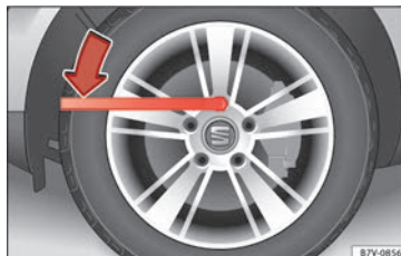
Afb. 66 Wiel verwisselen: de wielbouten losdraaien.
