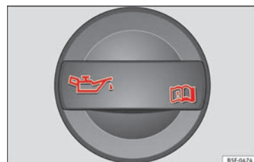
Afb. 54 In de motorruimte: dop van de motorolie-vulopening.
