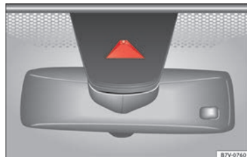
Afb. 219 Op de voorruit: Zichtveld van de camera van de rijstrookassistent.
