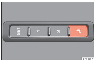
Afb. 155 Aan de zijkant van de voorstoel: toets voor de massagefunctie van lendensteun.
