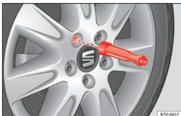
Afb. 70 Wiel verwisselen: de wielbouten met de schroevendraaiergreep losdraaien.
