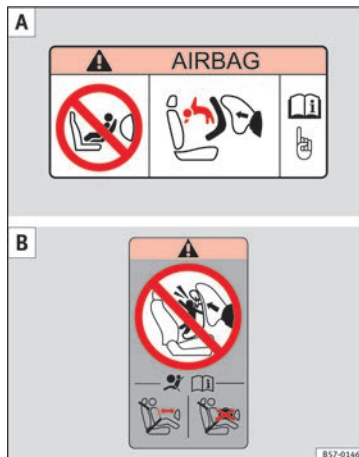
Afb. 35 Airbagstickers - versie 2: op de zonneklep aan bijrijderszijde A en op het achterste frame van het bijrijdersportier B .
