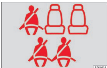
Afb. 82 Weergavevoorbeeld van de toestand van de gordel voor de plaatsen achterin (hier in een wagen met 7 plaatsen) in het instrumentenpaneel. boven, de tweede zitrij; onder, de derde zitrij.
