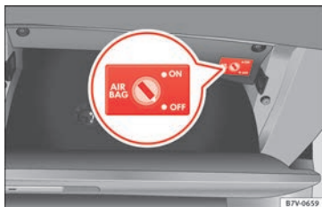
Afb. 27 In het dashboardkastje, aan de bijrijderszijde: sleutelschakelaar om de voorairbag aan bijrijderszijde in en uit te schakelen.
