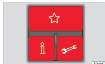
Afb. 122 3-toets module in hemelbekleding: bedieningstoetsen telefoon.
