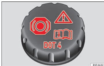
Afb. 247 In de motorruimte: dop van het remvloeistofreservoir.
