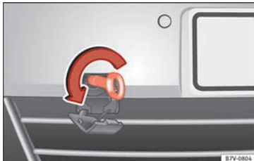
Afb. 71 Rechts op de voorbumper: schroef het sleepoog vast.
