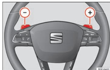
Afb. 203 Stuurwiel met twee hendels voor de Tiptronic.
