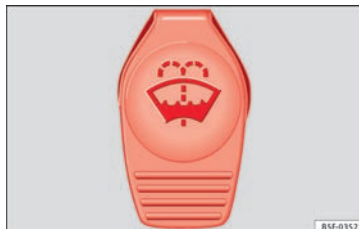
Afb. 57 In de motorruimte: dop van het ruitensproeiervloeistofreservoir.
