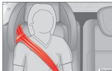
Afb. 95 Geïntegreerd kinderzitje: verloop van de gordelband met geleidebeugel.
