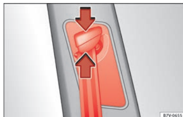
Afb. 89 Naast de voorstoelen: gordelhoogteverstelling.
