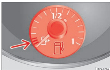
Afb. 235 In het instrumentenpaneel: brandstofmeter voor benzine en diesel.
