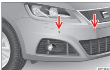
Afb. 208 Parkeerhulpsensoren in voorbumper.
