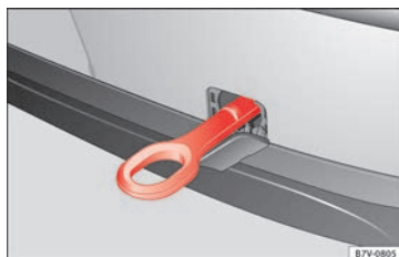
Afb. 103 Rechts op de achterbumper: vastgeschroefd sleepoog.
