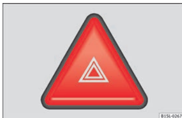
Afb. 139 In het midden van het instrumentenpaneel: drukknop voor alarmlichten.
