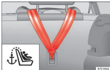
Afb. 38 Bovenste bevestigingsgordel vastgehaakt in de bagageruimte.
