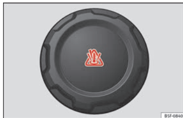
Afb. 55 Motorruimte: vulpop van het koelvloeistofexpansiereservoir.
