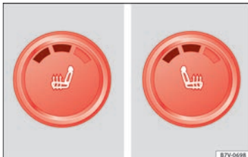
Afb. 153 Deel van de middenconsole: bedieningselementen voor de verwarming van de voorstoelen, hier met de tweede temperatuurstand ingesteld.
