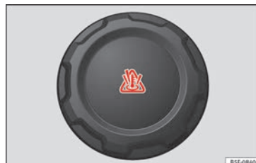
Afb. 246 In de motorruimte: vuldop van het koelvloeistofexpansiereservoir.
