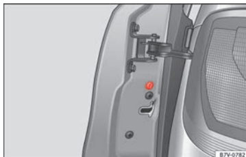
Afb. 4 Vooraan in de schuifdeur: noodslot, verborgen door een rubberen pakking.
