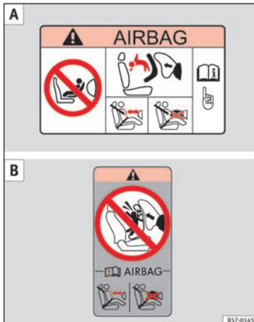
Afb. 34 Airbagstickers - versie 1: op de zonneklep aan bijrijderszijde A en op het achterste frame van het bijrijdersportier B .
