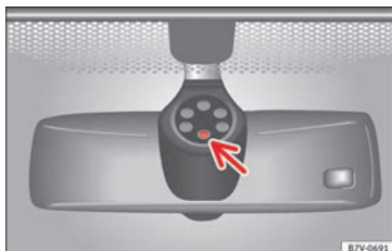
Afb. 144 Gevoelig oppervlak van de regensensor.
