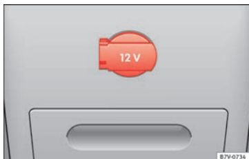
Afb. 192 Achterste gedeelte van middenconsole: 12-volt stopcontact
