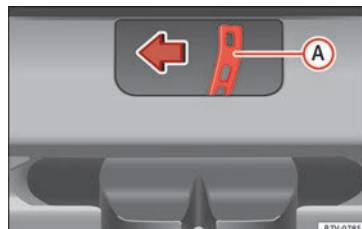
Afb. 9 Via de bagageruimte: noodontgrendeling van de achterklep.
