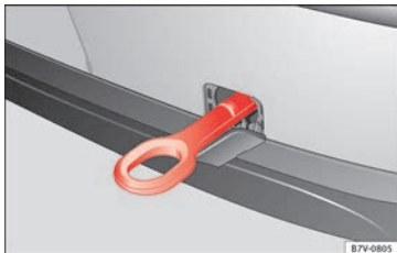
Afb. 72 Rechts op de achterbumper: vastgeschroefd sleepoog.
