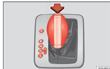
Afb. 48 Automatische versnellingsbak: keuzehendelstanden.
