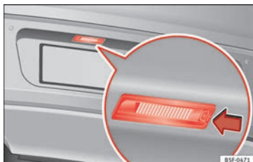
Afb. 114 In de achterbumper: kentekenplaatverlichting.
