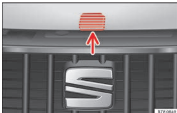
Afb. 240 Ontgrendelingshendel voor het openen van de motorkap in het ventilatierooster.
