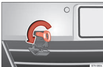
Afb. 102 Rechts op de voorbumper: schroef het sleepoog vast.
