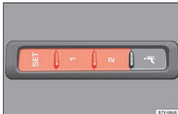
Afb. 156 Geheugentoetsen aan de buitenzijde van de bestuurdersstoel.
