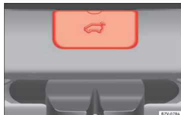
Afb. 8 Via de bagageruimte: demontage van de bedekking van de achterklep.
