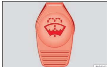
Afb. 248 In de motorruimte: dop van het ruitensproeiervloeistofreservoir.
