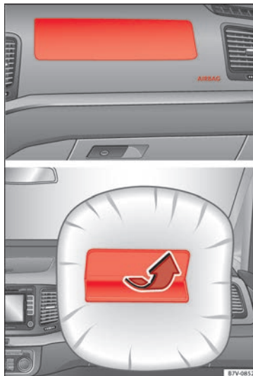
Afb. 26 Plaats en werkingsgebied van de voorairbag van de bijrijder.
