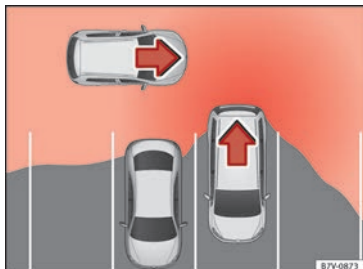
Afb. 225 Schematische voorstelling van de uitparkeerhulp: bewaakt gebied rond de wagen die een parkeerplaats verlaat.
