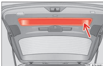
Afb. 136 Achterklep geopend: uitsparing voor dichttrekken.
