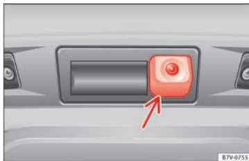
Afb. 214 In de achterklep: inbouwplaats van achteruitkijkcamera.
