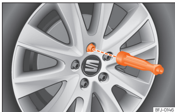
Afb. 49 Wiel verwisselen: de wielbouten met de schroevendraaiergreep losdraaien.
