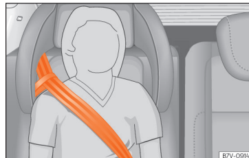
Afb. 35 Geïntegreerd kinderzitje: verloop van de gordel met geleidingshandvat.
