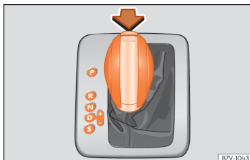
Afb. 238 keuzehendel van de automatische versnellingsbak met vergrendelingsknop (pijl).
