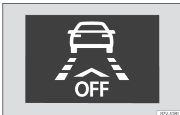
Afb. 253 Op het display van het instrumentenpaneel: aanwijzing van Front Assist uitgeschakeld.
