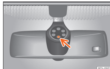
Afb. 122 Gevoelig oppervlak van de regensensor.
