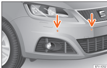
Afb. 272 Parkeerhulpsensoren in voorbumper.
