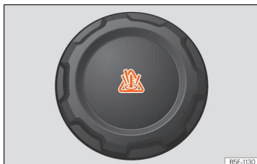
Afb. 291 Motorruimte: vuldop van het koelvloeistofexpansiereservoir.
