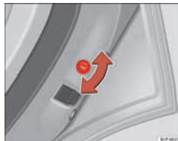
Afb. 61 Kinderslot in het rechterportier
