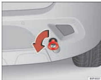
Afb. 200 Vastschroeven van het sleepoog aan achterzijde
