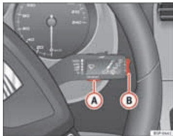
Afb. 45 Ruitenwisserhendel (MFA): toets A voor het bedienen van de keuzemogelijkheden en tuimelschakelaar B om van menu te wisselen
