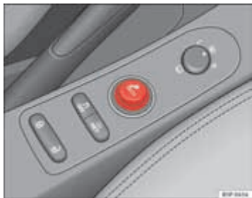
Afb. 118 De sigarettenaansteker zit in het stopcontact in de middenconsole voorin.
