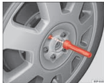
Afb. 183 Wiel verwisselen: Inbus sleutel voor het draaien van de bouten
