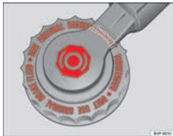
Afb. 174 In de motorruimte: vuldop van het remvloeistofreservoir
