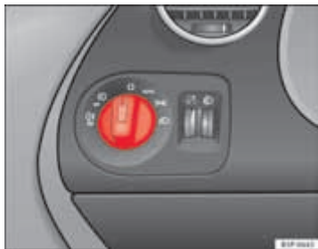
Afb. 73 Deel van het dashboard: lichtschakelaar, mistlampen en mistachterlicht
