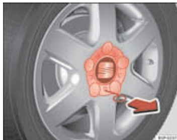
Afb. 178 Wiel verwisselen: Wieldop verwijderen
