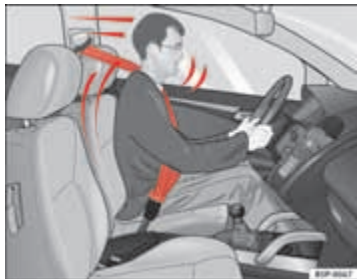
Afb. 11 Bestuurder met de veiligheidsgordel goed om: wordt bij plotseling remmen door de gordel tegengehouden
