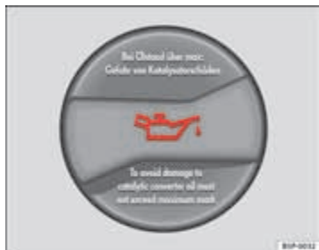
Afb. 167 In de motorruimte: dop van de motorolie-vulopening
