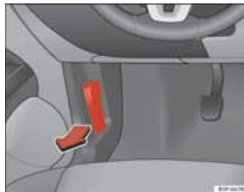
Afb. 163 Deel van de voetenruimte aan bestuurderszijde: ontgrendelingshendel voor de motorkap.
