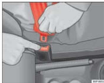
Afb. 16 Slotgesp uit het gordelslot losmaken
