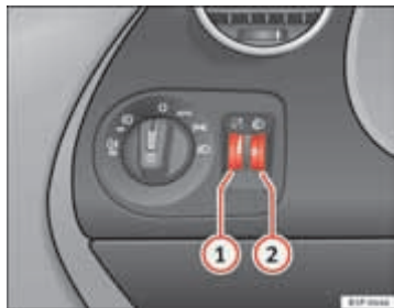
Afb. 75 Dashboard: regelaars voor instrumenten- en schakelaarverlichting en lichtbundel-hoogteverstelling
