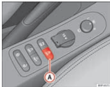
Afb. 141 Detail van de drukknop van de Start-Stop functie.
