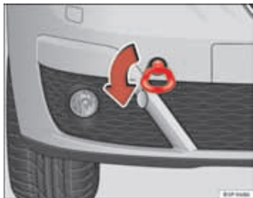
Afb. 207 Rechterschroeven van het sleepoog
