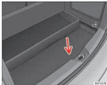
Afb. 177 Bagageruimte. Toegang tot het reservewiel
