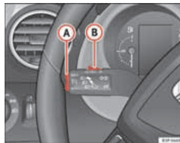
Afb. 154 Knipperlicht-en grootlichthendel: schakelaar en tuimelschakelaar voor het snelheidsregelsysteem
