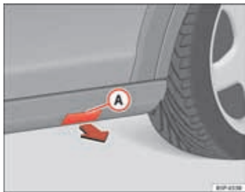
Afb. 182 Kunststof instapbekleding met deksel voor verankering van de krik
