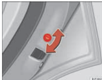
Afb. 62 Kinderslot in het rechterportier
