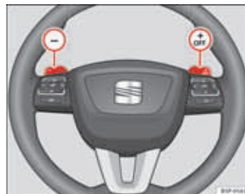
Afb. 150 Stuurwiel met hendels voor automatisch schakelen
