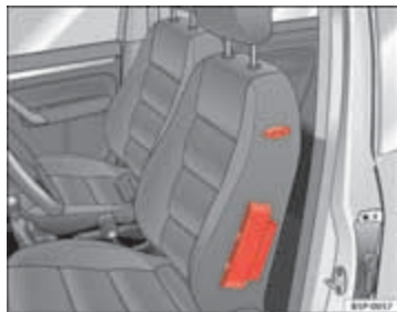
Afb. 22 Zijairbag in de bestuurdersstoel
