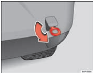
Afb. 208 Vastschroeven van het sleepoog aan achterzijde
