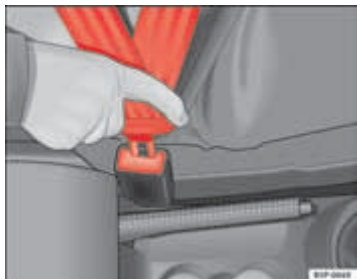
Afb. 12 Gordelslot en slotgesp van de veiligheidsgordel
