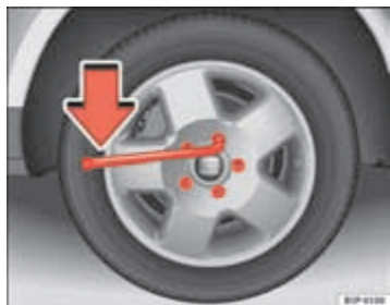
Afb. 179 Wiel verwisselen: de wielbouten losdraaien
