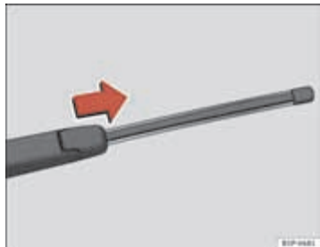
Afb. 172 Wisserblad van de achterraut verwijderen
