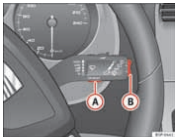
Afb. 44 Ruitenwisserhendel: toets A voor het bedienen van de keuzemogelijkheden en tuimelschakelaar B om van menu te wisselen
