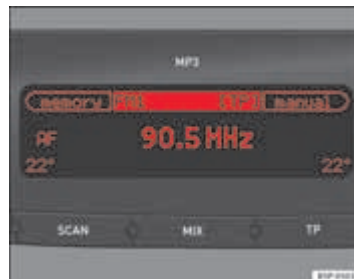
Afb. 134 Scherm van de radio met informatie van de Climatronic
