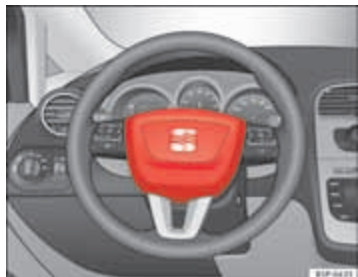
Afb. 18 Inbouwplaats bestuurdersairbag: in het stuurwiel
