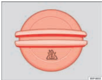
Afb. 168 In de motorruimte: Vuldop van het koelvloeistofexpansiereservoir
