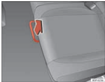
Afb. 98 Ontgrendelingsstang van de achterbank
