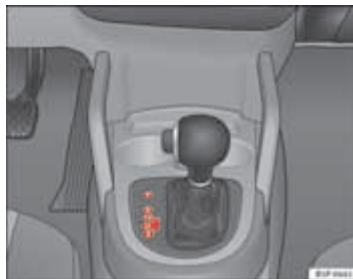
Afb.145 Middenconsole: keuzehendel van automatische versnellingsbak / automatische DSG-versnellingsbak
