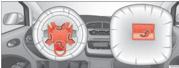
Afb. 21 Principeafbeelding: Airbagafdekkingen bij geactiveerde frontairbags
