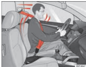
Afbeelding 11 Bestuurder met de veiligheidsgordel goed om: wordt bij plotseling remmen door de gordel tegengehouden
