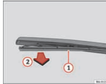
Afbeelding 164 Ruitenwisserblad achterruit vervangen
