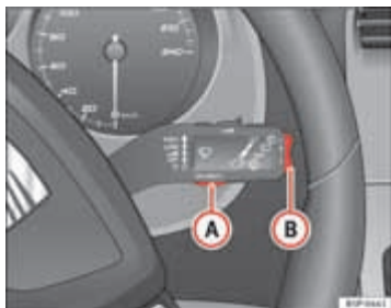
Afbeelding 44 Ruitenwischerhendel: toets A voor het bedienen van de keuzemogelijkheden en tuimelschakelaar B om van menu te wisselen
