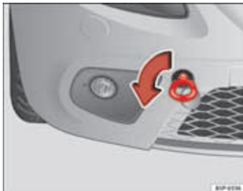
Afbeelding 198 Rechter- voorkant: vastschroeven van het sleepoog
