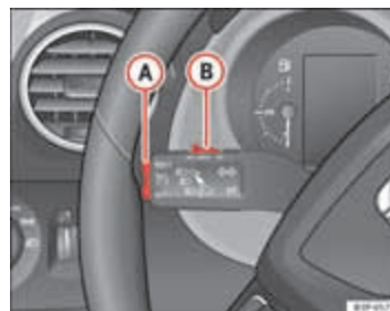
Afbeelding 148 Knipperlicht- en grootlichtbediening: schakelaar en tuimschakelaar voor het snelheidsregelsysteem
