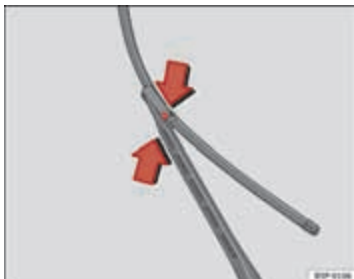
Afbeelding 163 Ruitenwischerbladen voorruit vervangen
