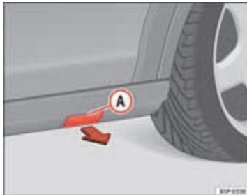
Afbeelding 181 Kunststof sideskirts met deksel voor verankering van de krik
