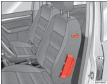
Afbeelding 22 Zijairbag in de bestuurdersstoel
