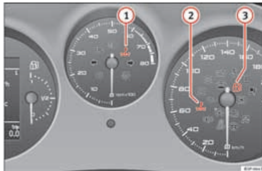
Afbeelding 51 Instrumentenpaneel met waarschuwings- en controlelampjes (wagens met LPG-systeem).
