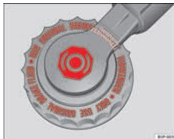
Afbeelding 173 In de motorruimte: vuldop van het remvloeistofreservoir
