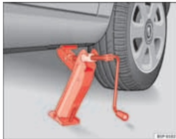
Afbeelding 180 Plaatsen van de krik
