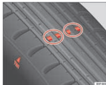
Afbeelding 174 Slijtage-merktekens van het bandenprofiel
