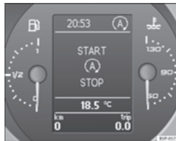
Afbeelding 141 Weergave op het display van het instrumentenpaneel tijdens de Start-Stop werking.
