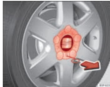
Afbeelding 177 Wiel verwisselen: Wieldop verwijderen
