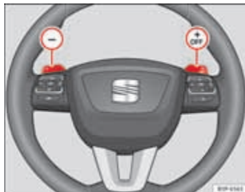
Afbeelding 149 Stuur-wiel met hendels voor au-tomatisch schakelen
