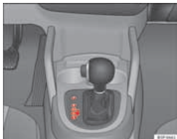
Abbeelding 144 Middenconsole: keuzehandel van automatische versnellingsbak / automatische versnellingsbak DSG
