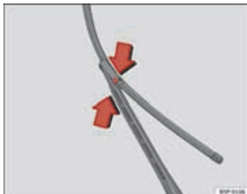
Afbeelding 171 Ruitenwischerbladen voorruit vervangen
