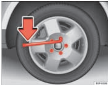
Afbeelding 178 Wiel verwisselen: de wielbouten losdraaien
