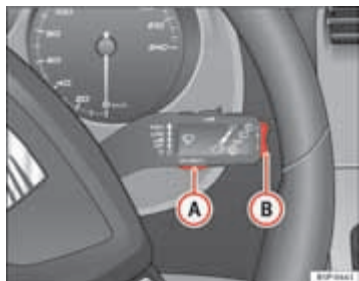
Afbeelding 47 Ruitenwischerhendel (MFA): toets A voor het bedienen van de keuzemogelijkheden en tuimelschakelaar B om van menu te wisselen
