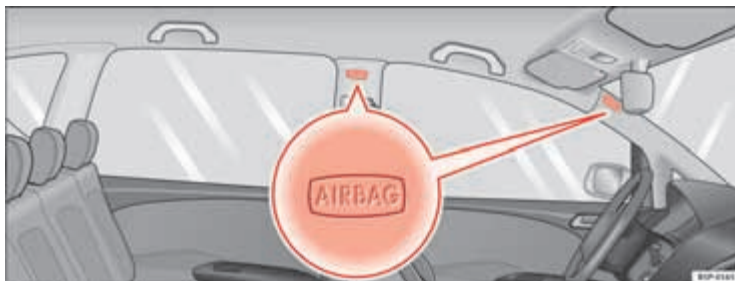
Afbeelding 24 Inbouwplaats van de hoofdainbags aan de linkerwagzijde
