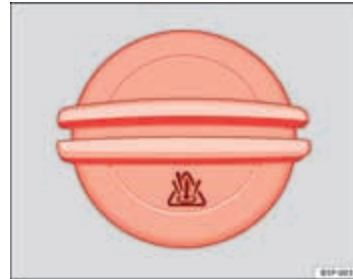
Abbeelding 168 In de motorruimte: vuldop van het koelvloeistofexpansiereservoir
