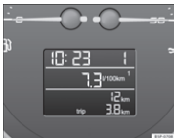
Afbeelding 44 Display in het instrumentenpaneel: weergave gemiddeld brandstofverbruik.
