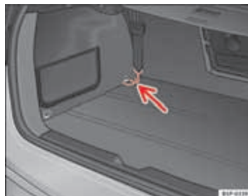
Afbeelding 126 Bevestigingsogen om het scheidingsnet te spannen ▶
