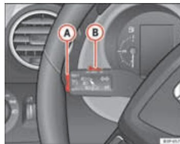
Afbeelding 154 Knipperlicht- en grootlichthendel: schakelaar en tuimelschakelaar voor het snelheidsregelsysteem
