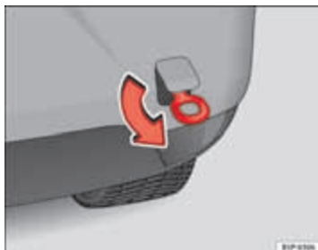
Afbeelding 207 Vast- schroeven van het sleep- oog aan achterzijde
