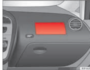
Afbeelding 19 Inbouwplaats bijrijdersairbag: in het dashboard
