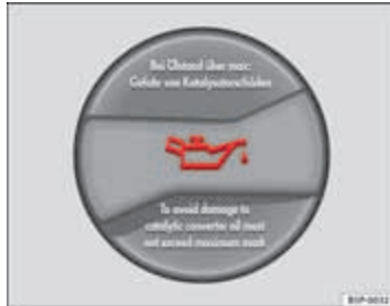
Afbeelding 167 In de motorruimte: dop van de motorolie-vulopening
