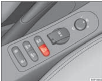
Afbeelding 136 Middenconsole: schakelaar van de gasinstallatie.
