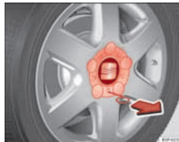
Afbeelding 174 Wiel verwisselen: Wieldop verwijderen
