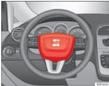
Afbeelding 18 Inbouwplaats bestuurdersairbag: in het stuurwiel
