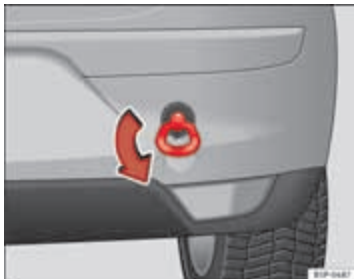
Afbeelding 204 Vast-schroeven van het sleepoog aan achterzijde
