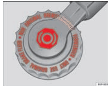
Afbeelding 170 In de motorruimte: vuldop van het remvloeistofreservoir ►
