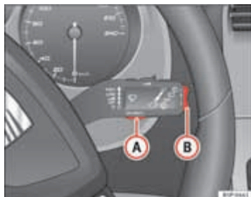
Afbeelding 45 Ruitenwischerhendel: toets A voor het bedienen van de keuzemogelijkheden en tuimelschakelaar B om van menu te wisselen
