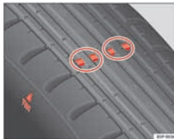
Afbeelding 171 Slijtage-merktekens van het bandenprofiel
