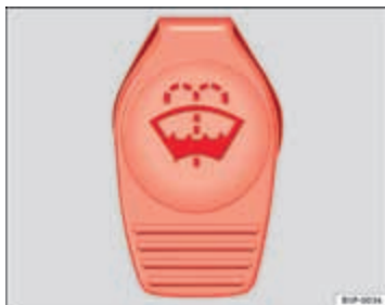
Abbeelding 165 In de motorruimte: vuldoop van het vloeistofreservoir ruitensproeier
