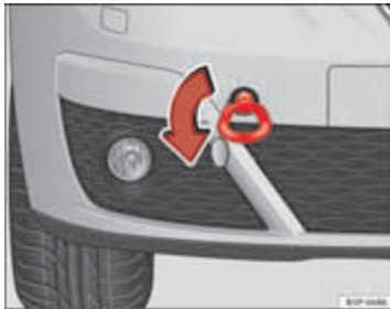
Afbeelding 203 Rechtervoorkant: vastschroeven van het sleepoog
