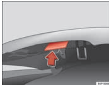
Afbeelding 161 Grendel voor het openen van de motorkap.
