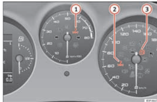
Afbeelding 51 Instrumentenpaneel met waarschuwings- en controlelampjes (wagens met LPG-systeem).
