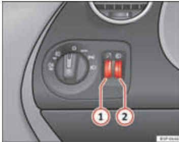
Afbeelding 74 Dashboard: regelaars voor instrumenten- en schakelaarverlichting en lichtbundel-hoogteverstelling
