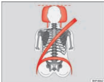
Afbeelding 13 Juist verloop van de gordelband en een juiste stand van de hoofdsteun van voren gezien
