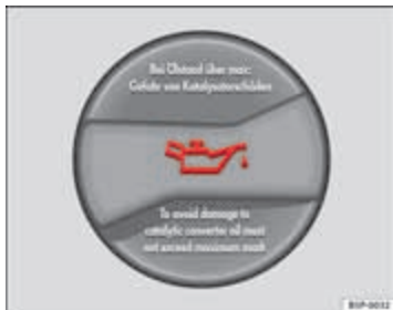
Afbeelding 163 In de motorruimte: dop van de motorolie-vulopening
