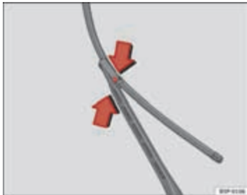
Afbeelding 167 Ruitenwisserbladen voorruit vervangen
