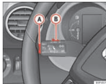
Afbeelding 151 Knipperlicht- en grootlichthendel: schakelaar en tuimelschakelaar voor het snelheidsregelsysteem
