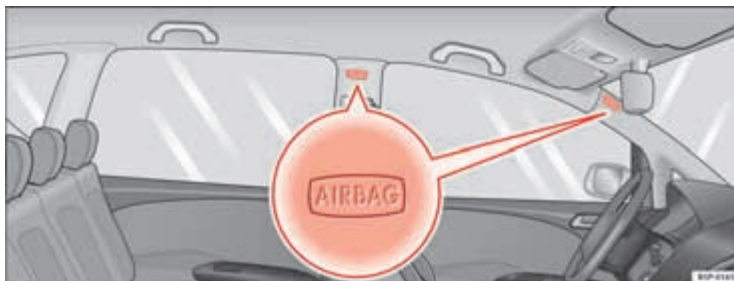
Afbeelding 24 Inbouwplaats van de hoofdainbags aan de linkerwagzijde
