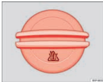
Afbeelding 164 In de motorruimte: vuldop van het koelvloeistofexpansiereservoir
