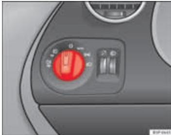
Afbeelding 72 Deel van het dashboard: lichtschaakelaar, mistlampen en mistachterlicht
