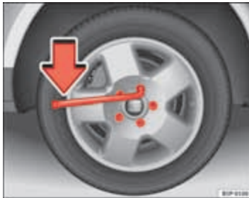
Afbeelding 175 Wiel verwisselen: de wielbouten losdraaien
