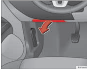
Afbeelding 179 Links in het dashboard: afdekking van de zekeringenhouder
