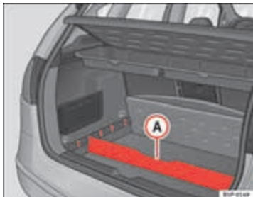
Afbeelding 106 Scheiding van de bagageruimtevloer
