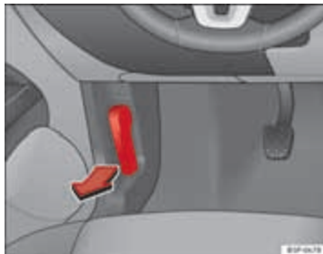
Afbeelding 160 Deel van de voetenruimte aan bestuurderszijde: ontgrendelingshendel voor de motorkap.
