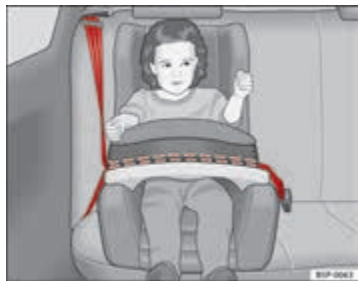
Afbeelding 29 In rijrichting geplaatst kinderzitje voor groep 1 op de achterbank.
