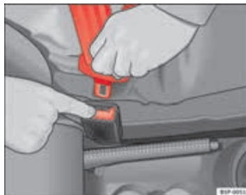
Afbeelding 16 Slotgesp uit het gordelslot losmaken
