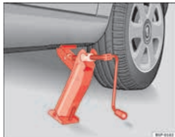
Afbeelding 182 Plaatsen van de krik
