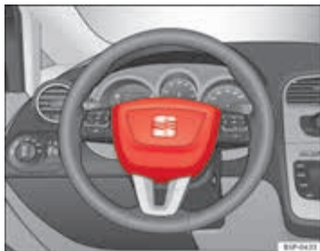
Afbeelding 18 Inbouw-plaats bestuurdersair-bag: in het stuurwiel
