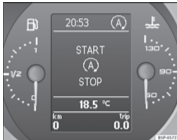
Afbeelding 143 Weergave op het display van het instrumentenpaneel tijdens de Start-Stop werking.
