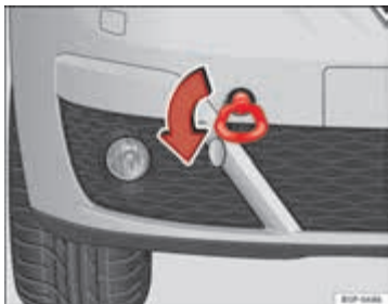
Afbeelding 216 Rechtervoorkant: vastschroeven van het sleepoog
