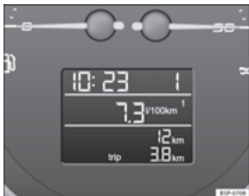
Afbeelding 44 Display in het instrumentenpaneel: weergave gemiddeld brandstofverbruik.
