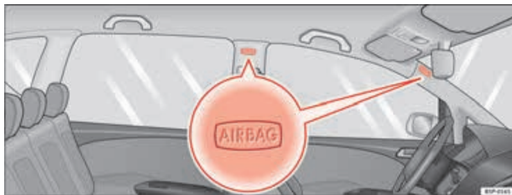
Afbeelding 24 Inbouwplaats van de hoofdairbags aan de linkerwagzijde
