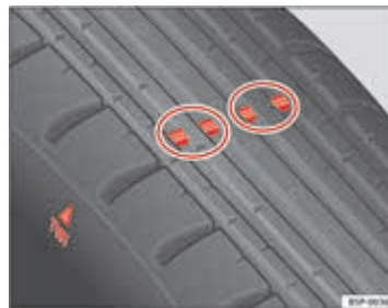
Afbeelding 176 Slijtage-merktekens van het bandenprofiel
