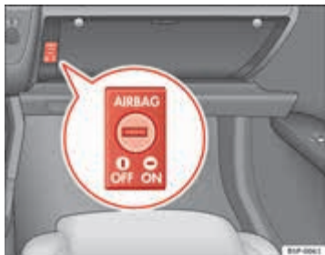
Afbeelding 26 In het dashboardkastje: sleutelschakelaar voor het in- en uitschakelen van de bijrijdersairbag
