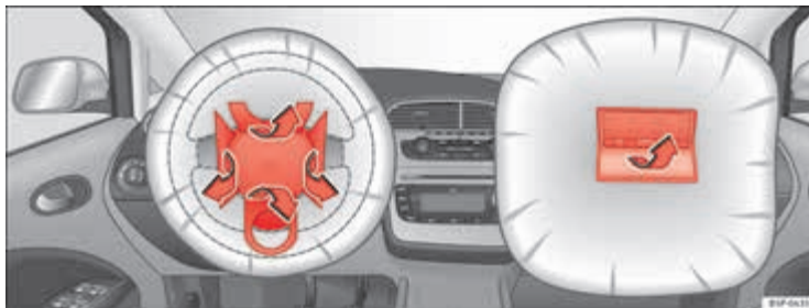
Afbeelding 21 Principeafbeelding: Airbagafdekkingen bij geactiveerde frontairbags
