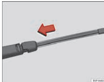
Afbeelding 173 Wisserblad van de achterraut plaatsen
