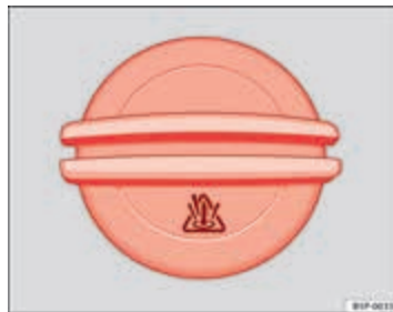
Afbeelding 168 In de motorruimte: vuldop van het koelvloeistofexpansiereservoir
