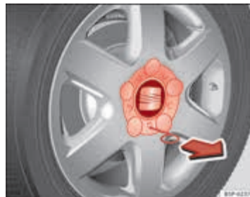
Afbeelding 179 Wiel verwisselen: Wieldop verwijderen
