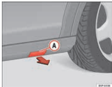
Afbeelding 183 Kunststof sideskirts met deksel voor verankering van de krik
