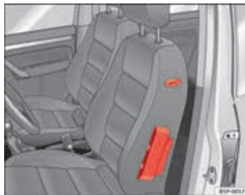
Afbeelding 22 Zijairbag in de bestuurdersstoel
