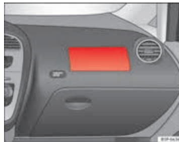
Afbeelding 19 Inbouw-plaats bijrijdersairbag: in het dashboard
