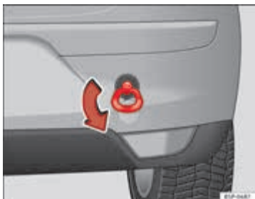
Afbeelding 217 Vast-schroeven van het sleepoog aan achterzijde
