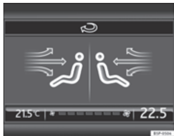
Afbeelding 134 Scherm van het navigatiesysteem met informatie van de Climatronic
