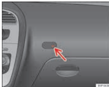
Afbeelding 27 Controlelampje voor buiten werking gestelde bijrijdersairbag
