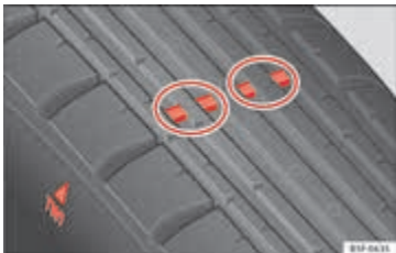
Afbeelding 152 Slijtagemerkttekens van het bandenprofiel.
