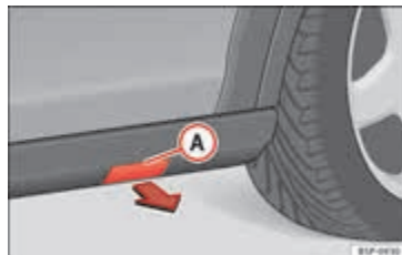
Afbeelding 160 Kunststof sideskirts met deksel voor verankering van de krik.
