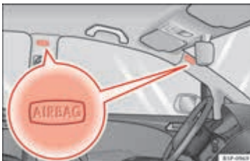
Afbeelding 17 Inbouwplaats van de hoofdairbags aan de linkerwagzijde.
