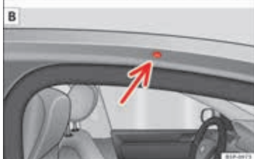
Afbeelding 112 Model Altea: bevestigingspunten voor het dakdragersysteem.
