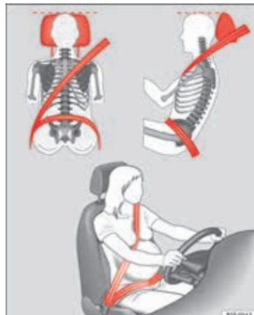
Afbeelding 11 Plaatsing van de gordelband bij de schouders en het bekken, en bij zwangere vrouwen.
