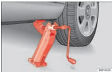
Afbeelding 159 Plaatsen van de krik.
