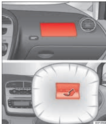
Afbeelding 14 Bijrijdersairbag in het dashboard.
