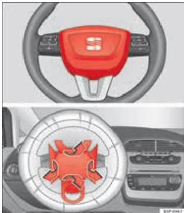
Afbeelding 13 Bestuurdersairbag in het stuurwiel.
