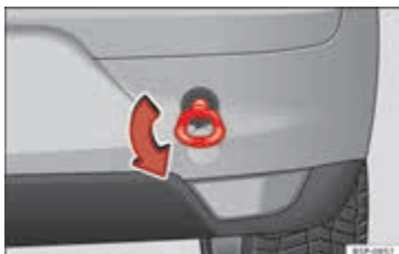
Afbeelding 166 Vastschroeven van het sleepoog aan de achterzijde.
