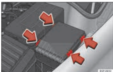
Afbeelding 174 In de motorruimte: deksel van de zekeringenhouder.
