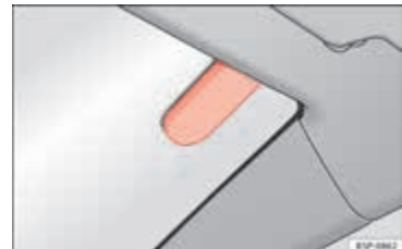
Afbeelding 70 Regensensor in de voorruit, gezien vanaf het interieur.
