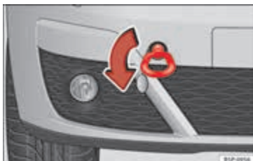
Afbeelding 165 Rechtervoorkant: vastschroeven van het sleepoog.
