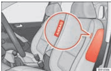
Afbeelding 15 Zij-airbag in de bestuurdersstoel.
