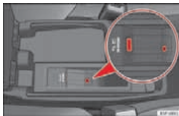
Afbeelding 115 Aansluiting in middenarmsteun. ▶
