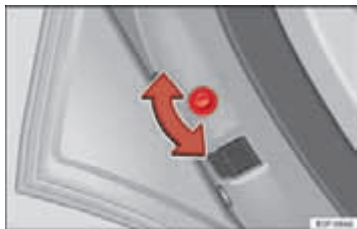
Afbeelding 57 Kinderslot in het linkerportier.
