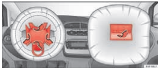
Afbeelding 21 Airbagafdekkingen bij geactiveerde voorairbags.
