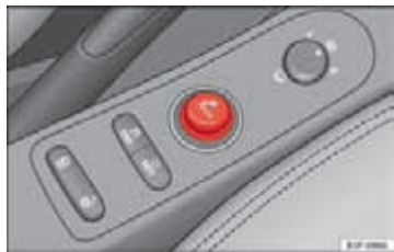
Afbeelding 110 De sigarettenaansteker zit in het stopcontact in de middenconsole voorin.
