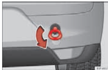
Afbeelding 211 Vast-schroeven van het sleepoog aan de achterzijde.
