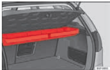
Afbeelding 116 ALTEA: behuizing voor de gevarendriehoek onder de hoedenplank.
