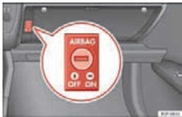
Afbeelding 22 In het dashboardkastje: sleutel-schakelaar voor het in- en uitschakelen van de bijrijdersairbag.
