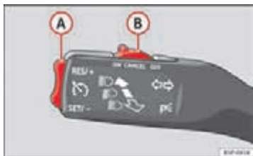
Afbeelding 149 Knipperlicht- en grootlichthendel: schakelaar en tuimelschakelaar voor het snelheidsregelsysteem.
