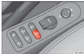
Afbeelding 136 Middenconsole: schakelaar van de gasinstallatie.
