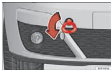
Afbeelding 210 Rechtervoorkant: vastschroeven van het sleepoog.
