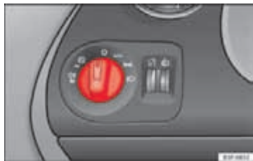
Abbeelding 69 Automatische inschakeling van de lichten.
