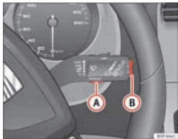
Afb. 46 Ruitenwisserhendel (MFA): toets A voor het bedienen van de keuzemogelijkheden en tuimelschakelaar B om van menu te wisselen
