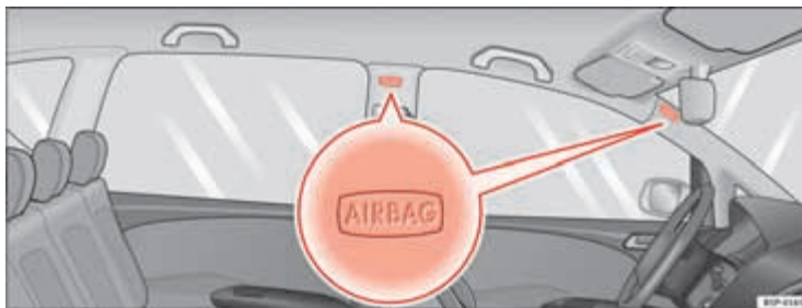
Afb. 24 Inbouwplaats van de hoofdairbags aan de linkerwagenzijde
