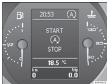
Afb. 140 Weergave op het display van het instrumentenpaneel tijdens de Start-Stop werking.
