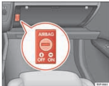
Afb. 26 In het dashboardkastje: sleutelschakelaar voor het in paraatheid brengen en buiten werking stellen van de bijrijdersairbag
