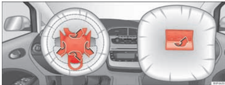
Afb. 21 Principeafbeelding: Airbagafdekkingen bij geactiveerde frontairbags
