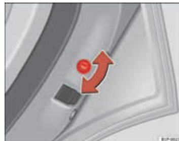
Afb. 62 Kinderslot in het rechterportier
