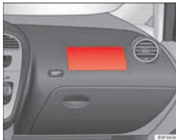
Afb. 19 Inbouwplaats bijrijdersairbag: in het dashboard
