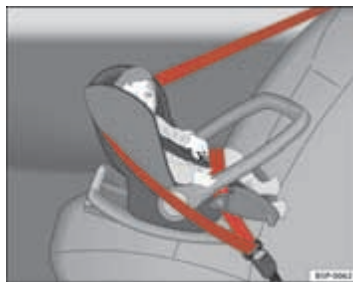
Afb. 28 Kinderzitje voor groep 0 op de achterstoel waarbij het kind met de rug naar het dashboard is gekeerd.
