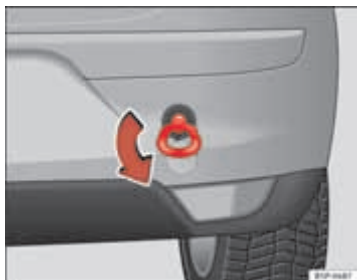
Afb. 206 Vastschroeven van het sleepoog aan achterzijde
