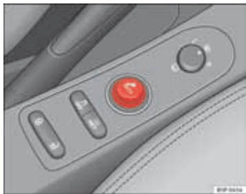
Afb. 117 De sigarettenaansteker zit in het stopcontact in de middenconsole voorin
