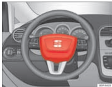
Afb. 18 Inbouwplaats bestuurdersairbag: in het stuurwiel
