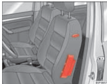
Afb. 22 Zijairbag in de bestuurdersstoel
