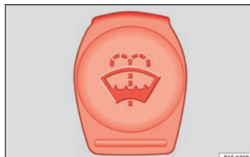
Afb. 69 In de motorruimte: dop van het ruitensproeiervloeistofreservoir.
