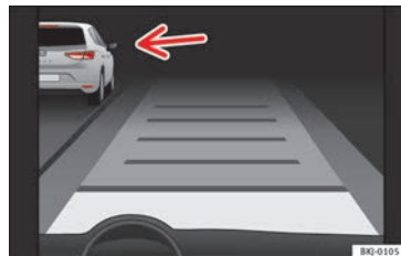
Afb. 198 Op het display van het instrumentenpaneel: ACC actief, voertuig herkend aan de linkerzijde
