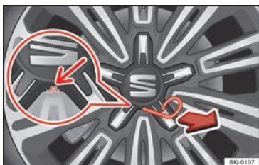
Afb. 78 Centrale wioldop verwijderen.
