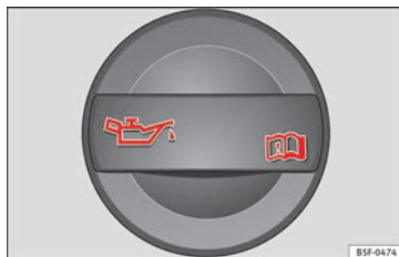
Afb. 66 In de motorruimte: dop van de motorolie-vulopening.
