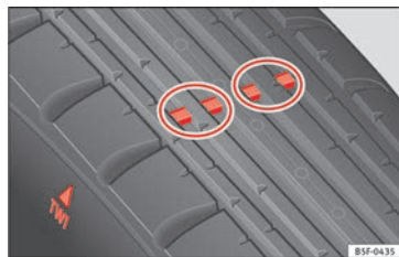
Afb. 240 Slijtagemerkttekens van het bandenprofiel.
