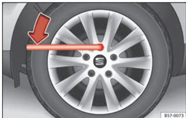
Afb. 81 Wiel verwisselen: de wielbouten losdraaien.
