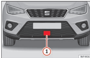
Afb. 190 Op de voorbumper: radarsensor.
