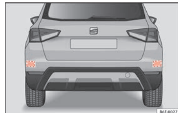
Afb. 202 Achteraanzicht van de wagen: zones van de radarsensoren.
