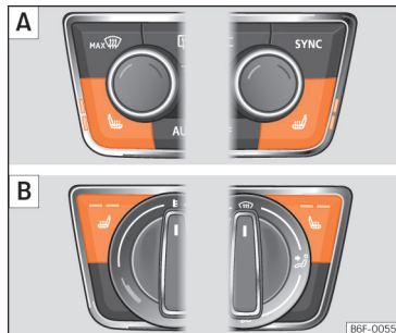
Afb. 150 In de middenconsole: bedieningsknoppen voor verwarming van de voorstoelen. [A] : versie met Climatronic. [B] : versie met handbediende airconditioning.
