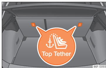
Afb. 34 Stand van de Top Tether-ringen aan de achterzijde van de achterbank.
