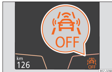
Afb. 232 Op het display van het instrumentenpaneel: indicatie van Front Assist uitgeschakeld.
