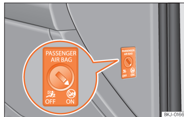
Afb. 94 Sleutelschakelaar voor het in- en uitschakelen van de bestuurdersairbag.
