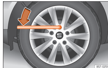
Afb. 72 Wiel verwisselen: wielbouten losdraaien.
