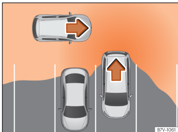
Afb. 246 Schematische voorstelling van de uitparkeerhulp: bewaakt gebied rond de wagen die een parkeerplaats verlaat
