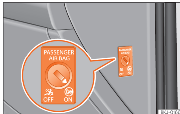
Afb. 17 Sleutelschakelaar voor het in- en uitschakelen van de bijrijdersairbag.
