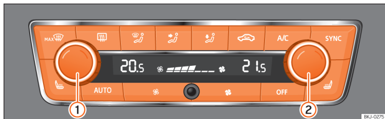
Afb. 137 In de middenconsole: bedieningselementen van de Climatronic.
