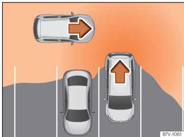
Afb. 244 Schematische weergave van de uitparkeerhulp: bewaakte zone rond de wagen die aan het uitparkeren is.
