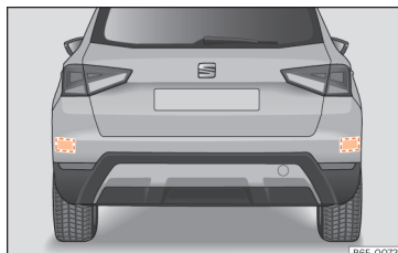
Afb. 241 Achteraanzicht van de wagen: zones van de radarsensor.
