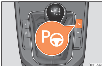
Afb. 247 In de middenconsole: toets om het inparkeersysteem in te schakelen.
