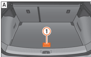
Afb. 128 Verstelbare bodem van de bagage-ruimte: schuine stand.
