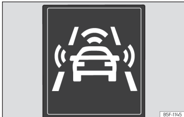
Afb. 227 Op het display van het instrumentenpaneel: aanwijzingen van voorwaarschuwing.
