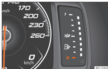
Afb. 74 Digitaal instrumentenpaneel: brandstofmeter.
