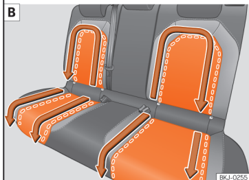
Afb. 123 De afneembare hoezen uitbouwen. A Stoel linksvoor; B Stoelen achterin
