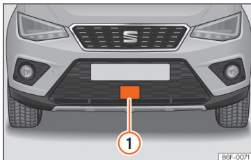
Afb. 234 In de voorbumper: radarsensor.
