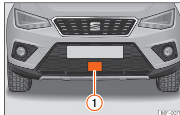
Afb. 228 In de voorbumper: radarsensor.
