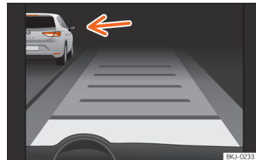
Afb. 237 Op het display van het instrumentenpaneel: ACC actief, voertuig herkend aan de linkerzijde
