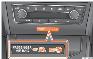
Afb. 18 Centraal gedeelte van het instrumentenpaneel: controlelampje voor buiten werking gestelde bijrijdersairbag.
