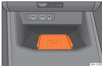
Afb. 207 In de middenconsole: steun voor het aansluiten van de mobiele telefoon.
