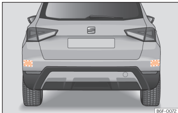
Afb. 147 Achteraanzicht van de wagen: zones van de radarsensor.
