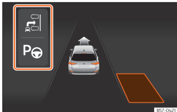
Afb. 170 Op het display van het instrumentenpaneel: beperkte weergave van het inparkeersysteem.
