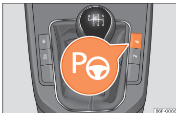
Afb. 169 In de middenconsole: toets om het inparkeersysteem in te schakelen.
