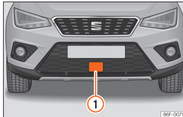
Afb. 145 In de voorbumper: radarsensor.
