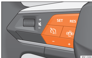
Afb. 145 Op het multifunctiestuurwiel: knoppen voor bediening van het snelheidsregelsysteem
