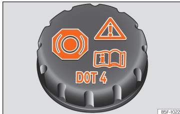
Afb. 198 Motorruimte: dop van het remvloeistofreservoir.
