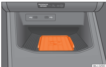
Afb. 127 In de middenconsole: steun voor het aansluiten van de mobiele telefoon.
