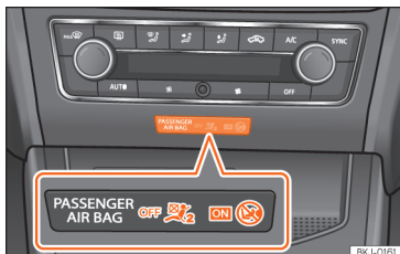
Afb. 17 Centraal gedeelte van het instrumentenpaneel: controlelampje voor buiten werking gestelde bijrijdersairbag.
