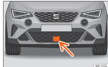
Afb. 139 In de voorbumper: radarsensor.
