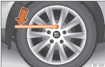
Afb. 35 Wiel verwisselen: wielbouten losdraaien.
