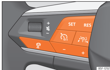
Afb. 157 Linkerzijde van het multifunctiestuurwiel: toetsen voor bediening van Travel Assist.
