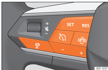
Afb. 149 Op het multifunctiestuurwiel: knoppen voor bediening van ACC
