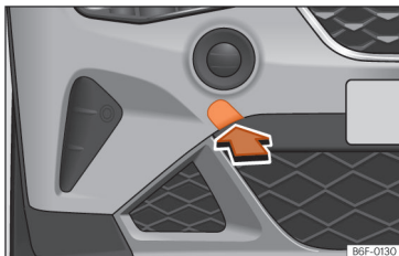
Afb. 44 Rechterzijde van de voorbumper: de afdekking verwijderen.
