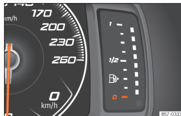
Afb. 66 Digitaal instrumentenpaneel: brandstofmeter.
