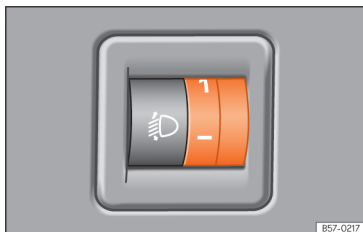
Afb. 96 Naast het stuur: lichtbundelhoogteverstelling
