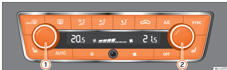
Afb. 119 In de middenconsole: bedieningselementen van de Climatronic.
