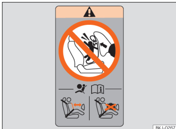
Afb. 23 Sticker van de airbag: in de achterste omlijsting van het bijrijdersportier
