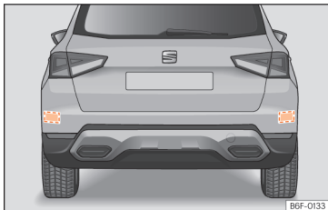
Afb. 142 Achteraanzicht van de wagen: zones van de radarsensor.
