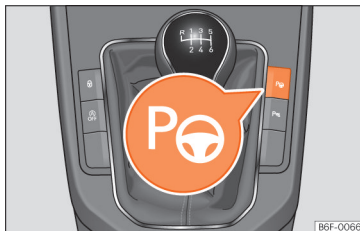
Afb. 163 In de middenconsole: toets om het inparkeersysteem in te schakelen.
