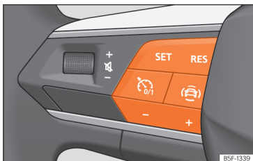
Afb. 102 Op het multifunctiestuurwiel: knoppen voor bediening van de snelheidsbegrenzer.
