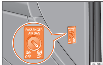
Afb. 30 Sleutelschakelaar voor het in- en uitschakelen van de bijrijdersairbag.
