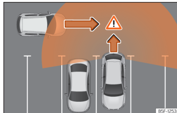
Afb. 130 Schematische voorstelling van de uitparkeerhulp: bewaakt gebied rond de wagen die een parkeerplaats verlaat
