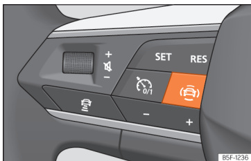
Afb. 94 Linkerzijde van het multifunctiestuurwiel: toets voor de bestuurdershulpsystemen (naargelang het model).
