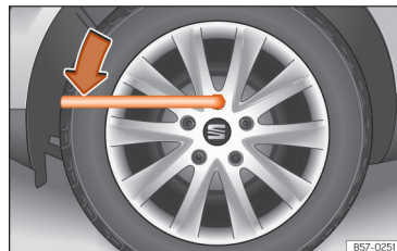
Afb. 196 Wiel verwisselen: wielbouten losdraaien.
