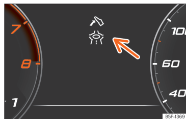
Afb. 12 Aanwijzing van het hulpsysteem voor eco-efficiënt rijden (schematische voorstelling).
