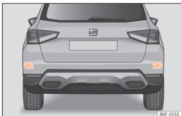
Afb. 98 Achteraanzicht van de wagen: zones van de radarsensoren.
