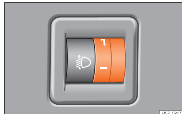
Afb. 73 Naast het stuur: lichtbundelhoogteverstelling.
