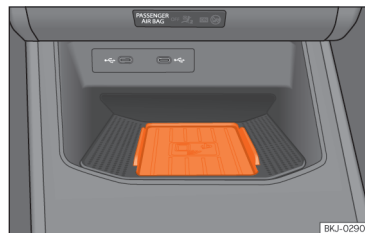
Afb. 141 In de middenconsole: steun voor het aansluiten van de mobiele telefoon.
