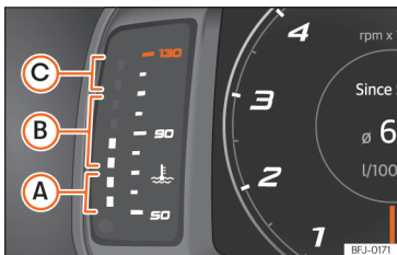
Afb. 9 Digitaal instrumentenpaneel SEAT Digital Cockpit: koelvloeistoftemperatuurmeter.
