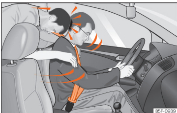
Afb. 23 De niet-vastgegespte passagier op een zitplaats achterin vliegt naar voren op de vastgegespte bestuurder.
