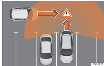
Afb. 129 Schematische voorstelling van de uitparkeerhulp: bewaakt gebied rond de wagen die een parkeerplaats verlaat
