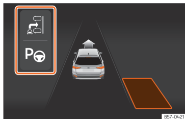
Afb. 123 Op het display van het instrumentenpaneel: beperkte weergave van het inparkeersysteem.
