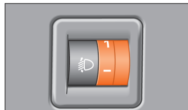
Afb. 73 Naast het stuur: lichtbundelhoogteverstelling.
