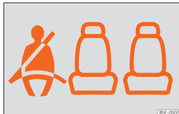
Afb. 21 Instrumentenpaneel: indicatie van de staat van de veiligheidsgordels voor de zitplaatsen achterin.
