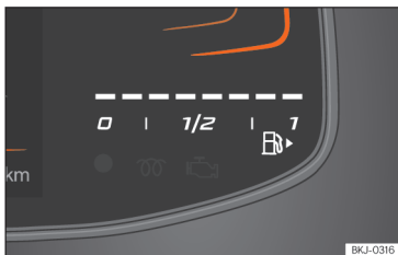
Afb. 5 Basic instrumentenpaneel: brandstofmeter.
