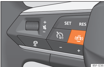
Afb. 93 Linkerzijde van het multifunctiestuurwiel: toets voor de bestuurdershulpsystemen (naargelang het model).
