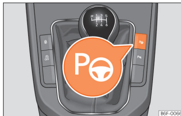
Afb. 122 In de middenconsole: toets om het inparkeersysteem in te schakelen.
