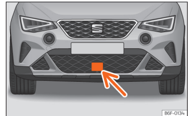
Afb. 94 In de voorbumper: radarsensor.
