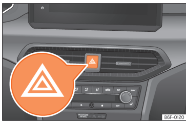
Afb. 44 Dashboard: schakelaar voor alarmlichten.
