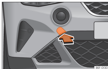
Afb. 163 Aan de rechterzijde van de voorbumper: de afdekking verwijderen.
