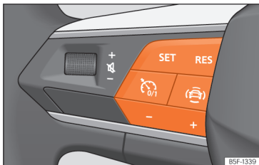
Afb. 101 Op het multifunctiestuurwiel: knoppen voor bediening van de snelheidsbegrenzer.
