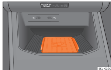
Afb. 144 In de middenconsole: steun voor het aansluiten van de mobiele telefoon.
