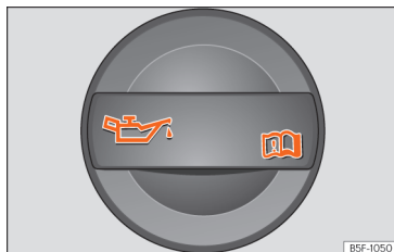
Afb. 188 In de motorruimte: dop van de motorolie-vulopening.
