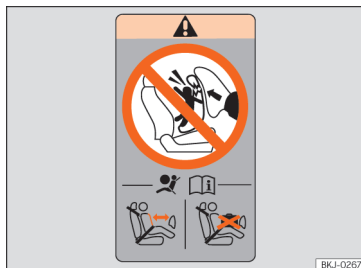
Afb. 36 Airbagsticker: in de achterste omlijsting van het bijrijdersportier.
