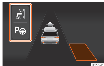
Afb. 126 Op het display van het instrumentenpaneel: beperkte weergave van het inparkeersysteem.
