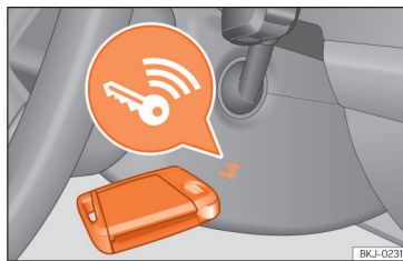
Afb. 84 Rechts van de stuurkolom: noodstart.
