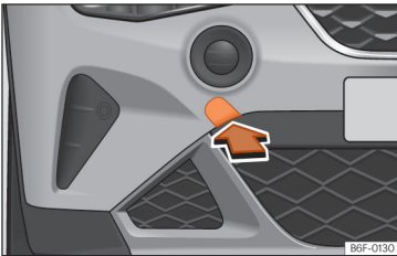
Afb. 165 Aan de rechterzijde van de voorbumper: de afdekking verwijderen.
