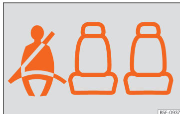
Afb. 20 Instrumentenpaneel: indicatie van de staat van de veiligheidsgordels voor de zitplaatsen achterin.
