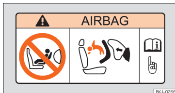
Afb. 35 Airbagsticker: op de zonneklep aan bijrijderszijde.
