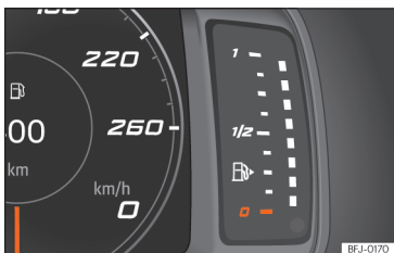
Afb. 6 Instrumentenpaneel SEAT Digital Cockpit: brandstofmeter.
