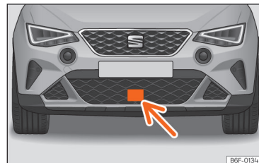
Afb. 94 In de voorbumper: radarsensor.
