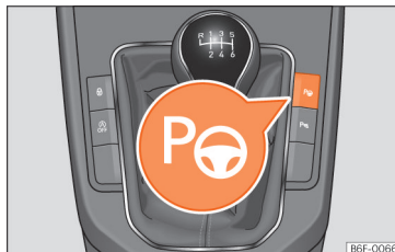
Afb. 125 In de middenconsole: toets om het inparkeersysteem in te schakelen.
