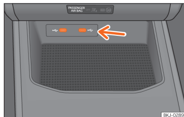
Fig. 137 Centre console: USB input.
