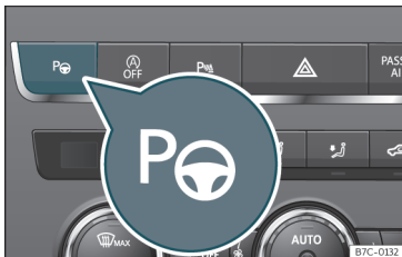
Afb. 226 Boven in de middenconsole: toets om het inparkeersysteem in te schakelen.
