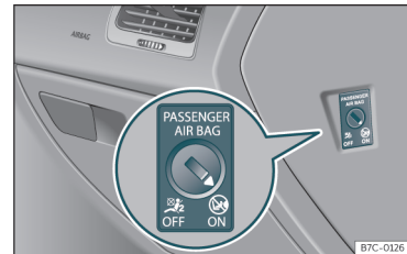
Afb. 81 Sleutelschakelaar voor het in- en uitschakelen van de bijrijdersairbag.
