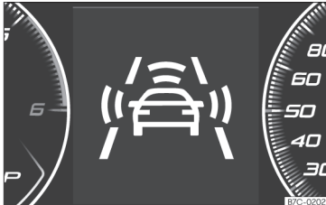
Afb. 206 In het display van het instrumentenpaneel: aanduidingen van voorwaarschuwing.
