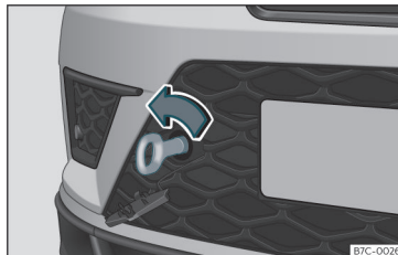
Afb. 64 Voorbumper rechts: ingeschroefd sleepoog.
