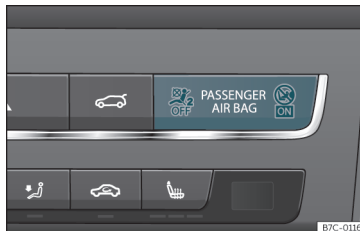
Afb. 23 Instrumentenpaneel: controlelampje van buiten werking stellen van de bijrijdersairbags.
