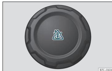
Afb. 51 Motorruimte: vuldop van het koelvloeistofexpansiereservoir.
