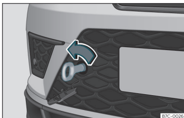
Afb. 85 Aan de rechterzijde van de voorbumper: vastgeschroefd sleepoog.
