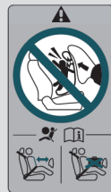
Afb. 30 Airbagstickers - versie 2: op de zonneklep aan bijrijderszijde [A] en op het achterste frame van het bijrijdersportier [B] .
