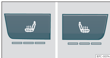
Afb. 127 In de middenconsole: bedieningsknop-pen voor verwarming van de voorstoelen.
