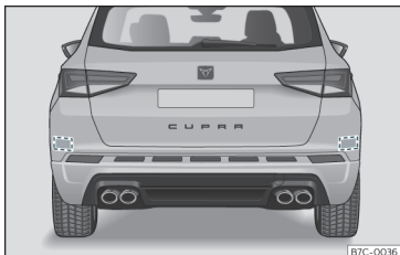
Afb. 221 Achteraanzicht van de wagen: zones van de radarsensoren.
