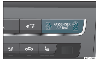
Afb. 82 Instrumentenpaneel: controlelampje van buiten werking stellen van de bijrijdersairbags.
