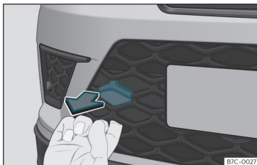
Afb. 84 Aan de rechterzijde van de voorbumper: de afdekking verwijderen.
