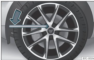
Afb. 61 Wiel: de wielbouten losdraaien.
