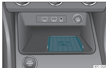
Afb. 193 In de middenconsole: steun voor het aansluiten van de mobiele telefoon.
