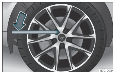
Afb. 32 Wiel verwisselen: wielbouten losdraaien.
