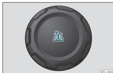
Afb. 260 Motorruimte: vuldop van het koelvloeistofexpansiereservoir.
