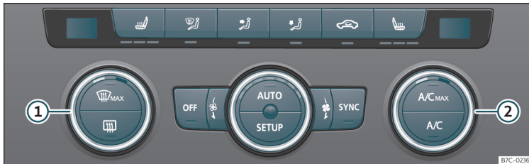
Afb. 122 In de middenconsole: bedieningselementen van de Climatronic.
