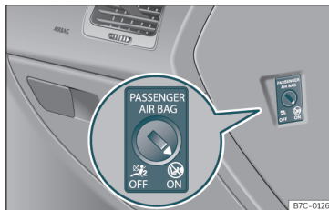
Afb. 14 Sleutelschakelaar voor het in- en uitschakelen van de bijrijdersairbag.
