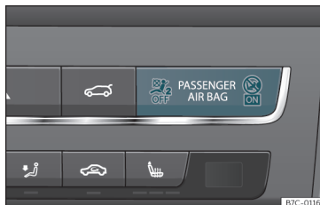
Afb. 15 Dashboard: controlelampje voor buiten werking gestelde bijrijdersairbag.
