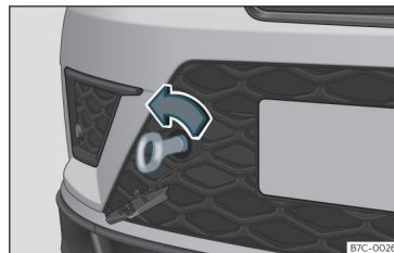
Afb. 40 Aan de rechterzijde van de voorbumper: vastgeschroefd sleepoog.
