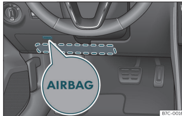
Afb. 16 Aan de bestuurderszijde: plaats van de airbag voor de knieën.
