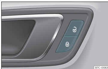
Afb. 70 Bestuurdersportier: schakelaar van de centrale vergrendeling.
