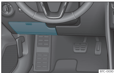
Afb. 43 Wagens met stuur links: afdekking van de zekeringenhouder onder het dashboard aan bestuurderszijde
