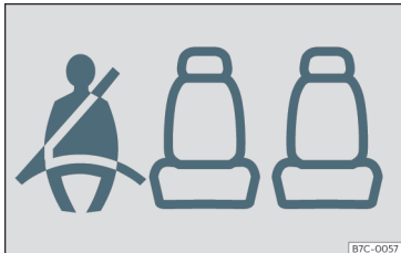
Afb. 4 Instrumentenpaneel: geeft aan dat de plaats linksachter bezet is en de overeenkomstige veiligheidsgordel juist is omgedaan.
