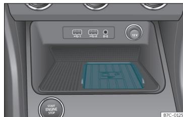
Afb. 196 In de middenconsole: steun voor het aansluiten van de mobiele telefoon.
