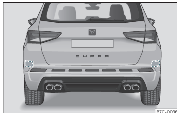
Afb. 226 Achteraanzicht van de wagen: zones van de radarsensor.
