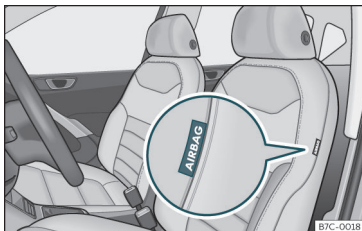
Afb. 18 Zij-airbag in de bestuurdersstoel.
