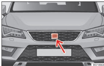
Afb. 179 Aan de voorzijde achter het SEAT-embleem: radarsensor.
