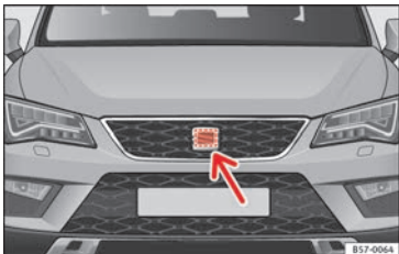
Afb. 187 Aan de voorzijde achter het SEAT-embleem: radarsensor.
