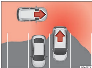
Afb. 198 Schematische voorstelling van de uitparkeerhulp: bewaakt gebied rond de wagen die een parkeerplaats verlaat.
