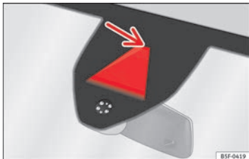
Afb. 193 Op de voorruit: gezichtsveld van de rijstrookassistent.
