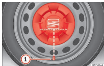
Afb. 69 Juiste plaatsing van de centrale wioldop voor stalen velgen.
