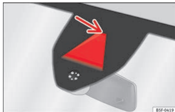
Afb. 202 Op de voorruit: gezichtsveld van de rijstrookassistent.
