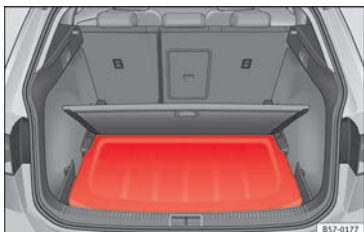
Afb. 162 In de bagageruimte: plaatsen van de hoedenplank.
