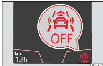
Afb. 192 Op het display van het instrumentenpaneel: indicatie van Front Assist uitgeschakeld.
