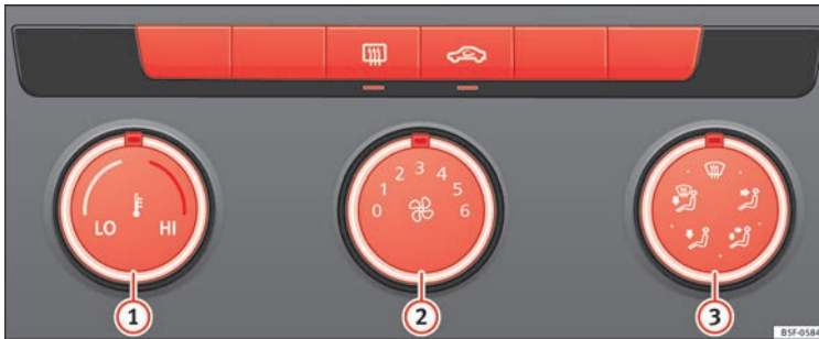
Afb. 59 In de middenconsole: bedieningselementen voor verwarming en ventilatie.
