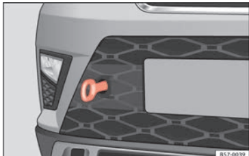
Afb. 77 Voorbumper rechts: vastgeschroefd sleepoog.
