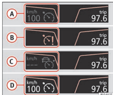
Afb. 186 Display in het instrumentenpaneel: statusaanduidingen van GRA.
