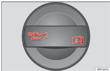
Afb. 241 In de motorruimte: dop van de motorolie-vulopening.
