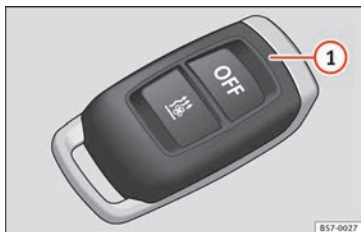
Afb. 176 Interieurvoorverwarming: radiografische afstandsbediening.
