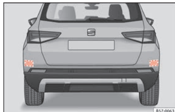
Afb. 208 Achteraanzicht van de wagen: zones van de radarsensoren.
