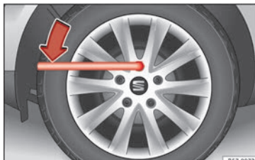
Afb. 74 Wiel: de wielbouten losdraaien.
