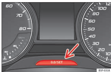
Afb. 120 Instrumentenpaneel: kilometerteller en resetknop.
