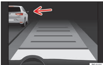
Afb. 199 Op het display van het instrumentenpaneel: ACC actief, voertuig herkend aan de linkerzijde
