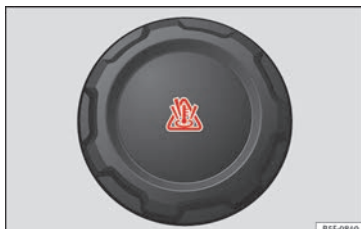
Afb. 63 Motorruimte: vuldop van het koelvloeistofexpansiereservoir.
