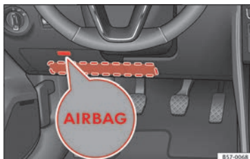
Afb. 24 Aan de bestuurderszijde: plaats van de airbag voor de knieën.
