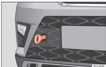
Afb. 99 Aan de rechterzijde van de voorbumper: vastgeschroefd sleepoog.
