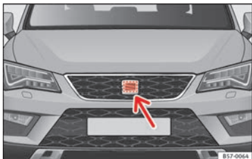
Afb. 191 Aan de voorzijde achter het SEAT-embleem: radarsensor.
