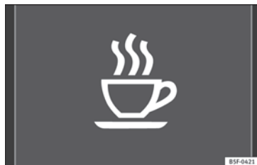
Afb. 215 Op het display van het instrumentenpaneel: symbool voor detectie van vermoeidheid.
