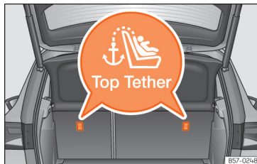
Afb. 40 Stand van de Top Tether-ringen aan de achterzijde van de achterbank.
