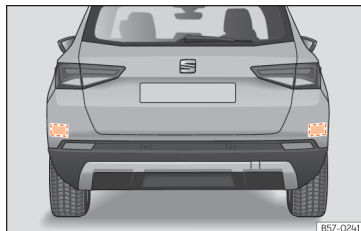
Afb. 272 Achteraanzicht van de wagen: zones van de radarsensoren.
