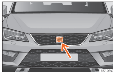
Afb. 255 Aan de voorzijde achter het SEAT-embleem: radarsensor.
