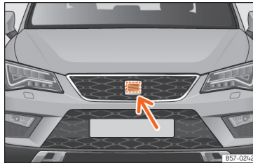
Afb. 257 Aan de voorzijde achter het SEAT-embleem: radarsensor.
