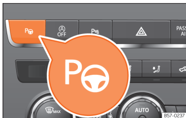
Afb. 282 Boven in de middenconsole: toets om het inparkeersysteem in te schakelen.
