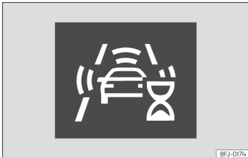
Afb. 259 Op het display van het instrumentenpaneel: aanwijzing van initiële zelfkalibratie van het systeem.
