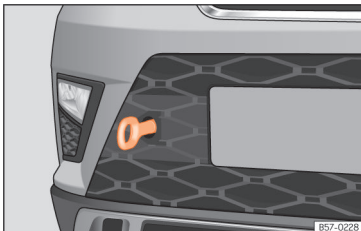
Afb. 48 Aan de rechterzijde van de voorbumper: vastgeschroefd sleepoog.
