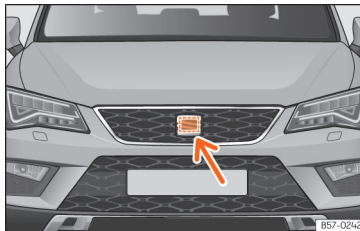
Afb. 263 Aan de voorzijde achter het SEAT-embleem: radarsensor.
