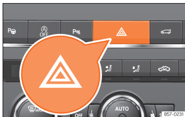
Afb. 115 Dashboard: schakelaar voor alarmlichten.
