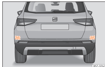
Afb. 275 Achteraanzicht van de wagen: zones van de radarsensor.
