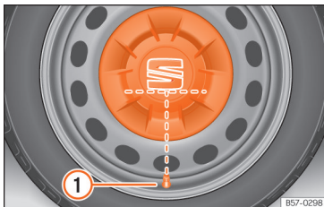
Afb. 35 Juiste plaatsing van de centrale wioldop voor stalen velgen.
