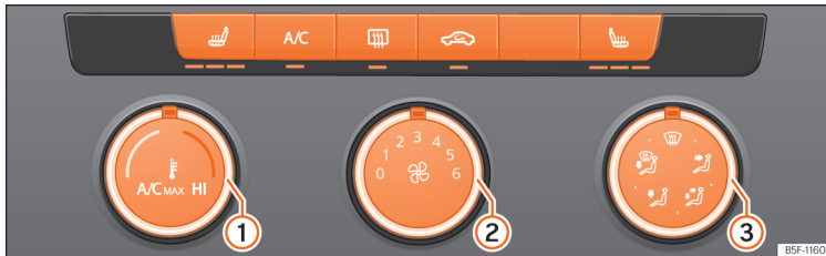
Afb. 154 In de middenconsole: Knoppen voor de handbediende airconditioning.
