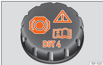
Afb. 315 Motorruimte: dop van het remvloeistofreservoir.
