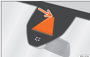
Afb. 269 Op de voorruit: gezichtsveld van de rijstrookassistent.
