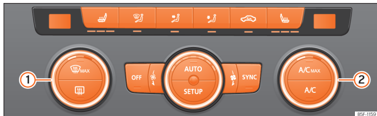
Afb. 153 In de middenconsole: bedieningselementen van de Climatronic.
