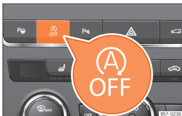
Afb. 241 Middenconsole: toets van het start-stopsysteem.
