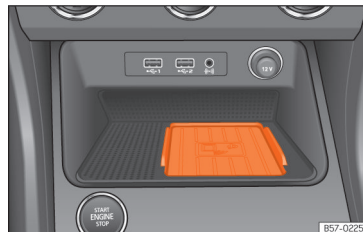
Afb. 237 In de middenconsole: steun voor het aansluiten van de mobiele telefoon.
