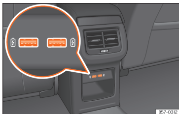
Afb. 235 Achterzijde middenconsole: USB-aansluitingen.
