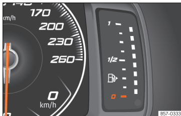
Afb. 76 Digitaal instrumentenpaneel: brandstofmeter.
