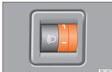
Afb. 116 Naast het stuur: lichtbundelhoogteverstelling
