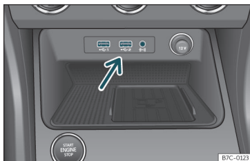
Fig. 194 Centre console: USB/AUX-IN input.
