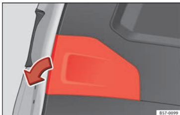
Fig. 112 Rear lid open: remove the lid.
