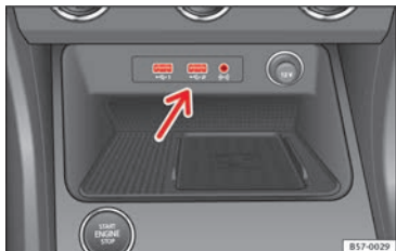
Fig. 121 Centre console: USB/AUX-IN input.
