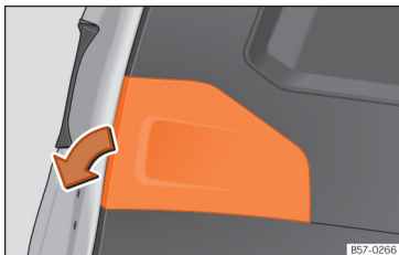
Fig. 116 Rear lid open: remove the lid.
