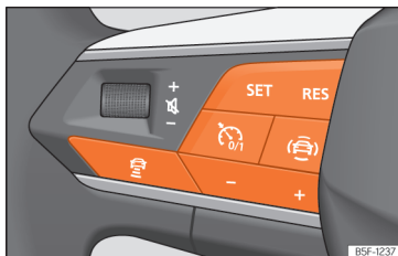
Afb. 169 Op het multifunctiestuurwiel: knoppen voor bediening van ACC
