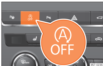
Afb. 151 Middenconsole: toets van het start-stopsysteem.
