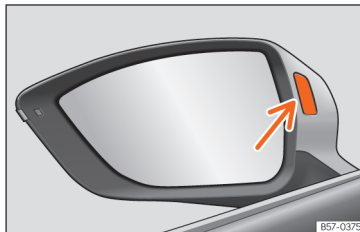
Afb. 178 Controlelampje van de rijstrookwisselhelp.
