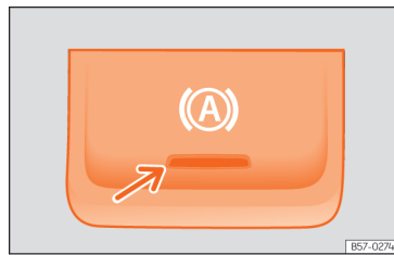
Afb. 184 Onder in de middenconsole: toets van de Auto Hold-functie.
