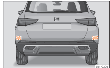
Afb. 161 Achteraanzicht van de wagen: zones van de radarsensor.
