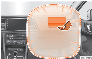
Afb. 15 Bijrijdersairbag in het dashboard.
