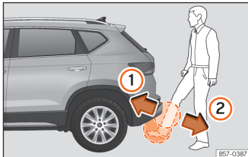
Afb. 89 Achterklep sensorgestuurd openen (Easy Open).
