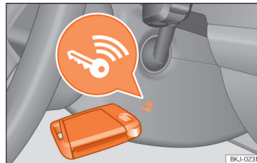
Afb. 150 Rechts van de stuurkolom: noodstart.
