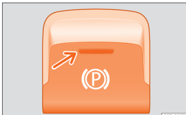
Afb. 183 Onder in de middenconsole: toets van de elektronische parkeerrem.
