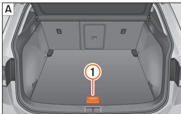
Afb. 121 Verstelbare bodem van de bagage-ruimte: schuine stand.
