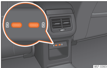
Afb. 148 Achterzijde middenconsole: USB-aansluitingen met functie van stroomvoorziening.
