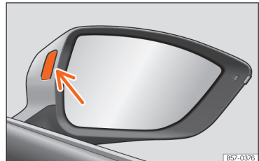
Afb. 179 Controlelampje van de rijstrookwisselhelp.
