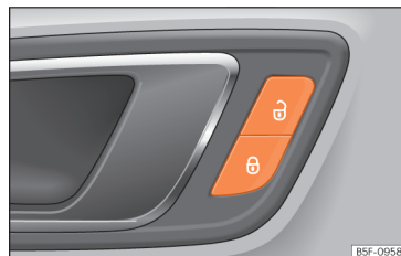
Afb. 79 Bestuurdersportier: schakelaar van de centrale vergrendeling.
