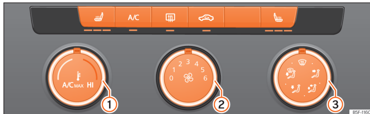
Afb. 136 In de middenconsole: Knoppen voor de handbediende airconditioning.
