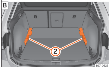
Afb. 120 Verstelbare bodem van de bagage-ruimte: A ) hoge stand; B ) lage stand.
