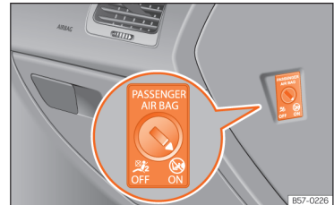
Afb. 16 Sleutelschakelaar voor het in- en uitschakelen van de bijrijdersairbag.
