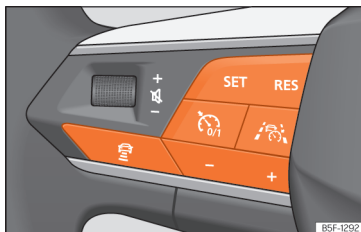
Afb. 177 Linkerzijde van het multifunctiestuurwiel: toetsen voor bediening van Travel Assist.
