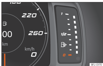
Afb. 60 Digitaal instrumentenpaneel: brandstofmeter.
