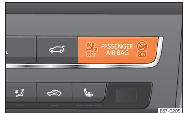
Afb. 17 Dashboard: controlelampje voor buiten werking gestelde bijrijdersairbag.
