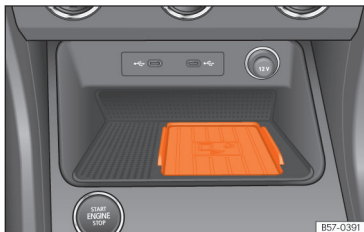
Afb. 146 In de middenconsole: steun voor het aansluiten van de mobiele telefoon.
