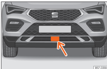
Afb. 158 In de voorbumper: radarsensor.
