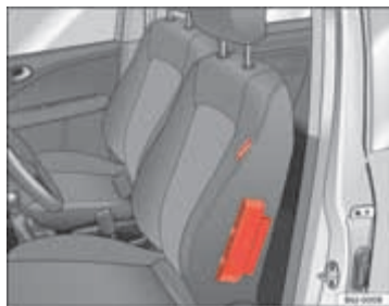
Afb. 23 Zijairbag in de bestuurdersstoel
