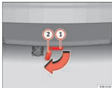
Afb. 163 Achterbumper: Afsluitdop openklappen
