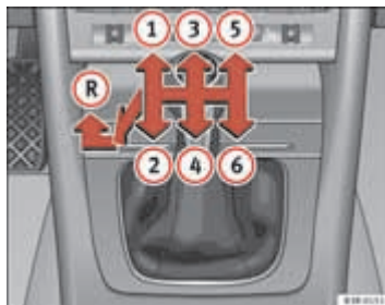
Afb. 153 Deel van de middenconsole: schakelschema van een 6-versnellings schakelbak
