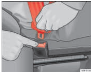
Afb. 15 Slotgesp uit het gordelslot losmaken
