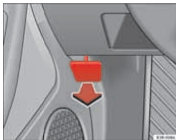
Afb. 176 Deel van de voetenruimte aan bestuurderszijde: ontgrendelingshendel voor de motorkap.
