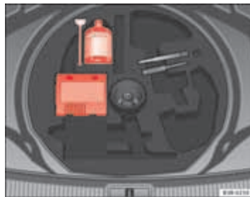
Afb. 193 Bandenreparatieset (tire mobility-systeem) onder de vloer in de bagageruimte
