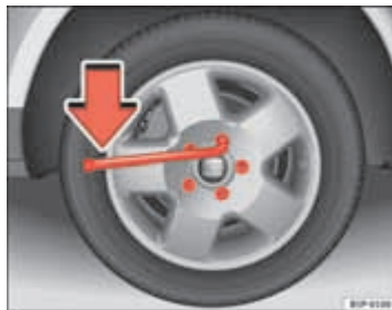
Afb. 195 Wiel verwisselen: Wielbouten losdraaien
