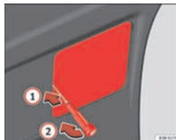
Afb. 233 Afdekking in de achterklepbekleding verwijderen
