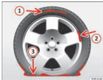
Afb. 200 Bandenbeschadiging waarvoor het Tire-Mobility-systeem niet geschikt is
