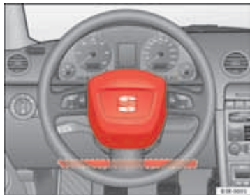
Afb. 17 Bestuurdersairbag in het stuur en knie-airbag in het dashboard
