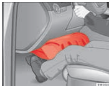
Afb. 22 De opgeblazen airbags bieden bescherming bij een frontale botsing. ▶
