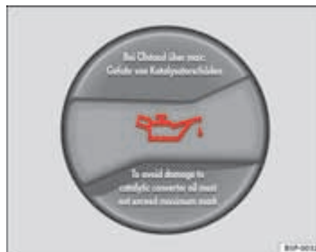
Afb. 180 In de motorruimte: dop van de motorolie-vulopening
