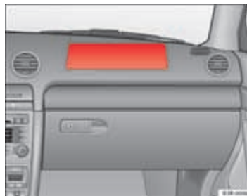
Afb. 18 Inbouwplaats bijrijdersairbag in het dashboard
