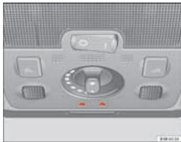
Afb. 94 Deel van de hemelbekleding: Sfeerverlichting
