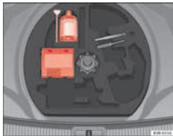
Afb. 181 Bandenreparatieset (tire mobility-systeem) onder de vloer in de bagageruimte
