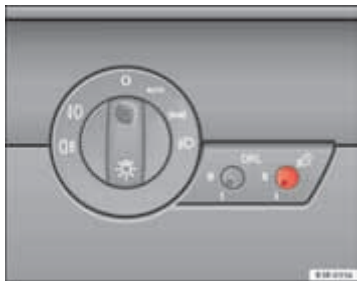
Afb. 86 Deel van het dashboard: Functies coming home en leaving home
