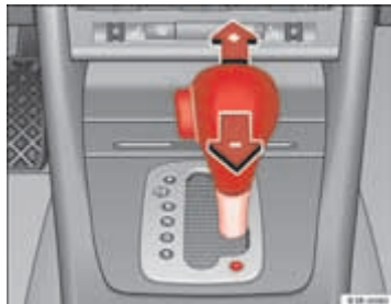
Afb. 148 Middenconsole: Handmatig schakelen (tiptronic-functie)
