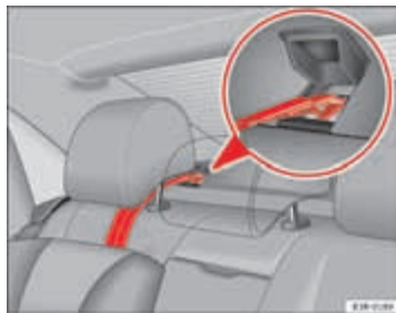
Afb. 35 Bevestigingsband: juiste afstelling en montage
