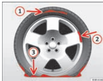
Afb. 188 Bandenbeschadiging waarvoor het Tire-Mobility-systeem niet geschikt is
