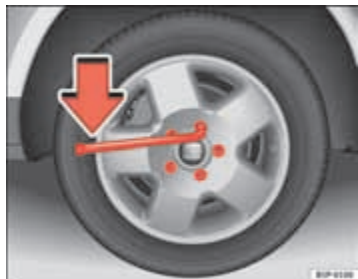
Afb. 183 Wiel verwisselen: Wielbouten losdraaien
