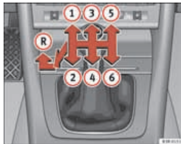
Afb. 144 Deel van de middenconsole: schakelschema van een 6-versnellings schakelbak
