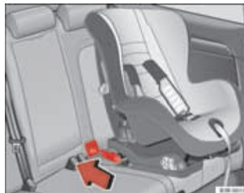
Afb. 33 De ISOFIX-verankeringen van het kinderzitje glijden over de reeds ingebouwde kunststofgeleidingen tot deze bevestigd worden aan de ISOFIX-verankeringen van de wagen
