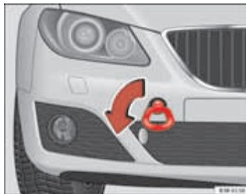
Afb. 231 Vastschroeven van het sleepoog aan voorzijde van de wagen
