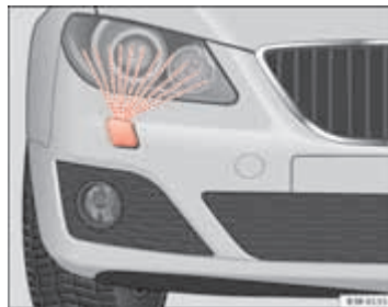
Afb. 102 Koplampen met uitgeschoven koplampsproeier ▶
