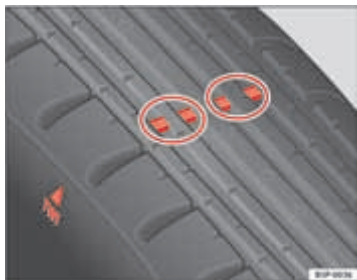
Afb. 178 Slijtagemerktens van het bandenprofiel
