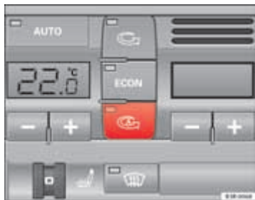
Afb. 133 Bedienings-toets voor de automatische circulatiefunctie
