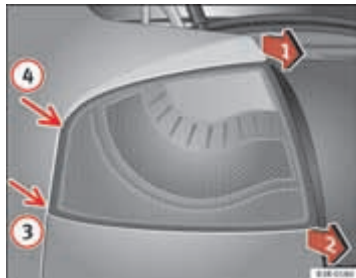
Afb. 214 Uitbouwen van achterlicht in zijpaneel
