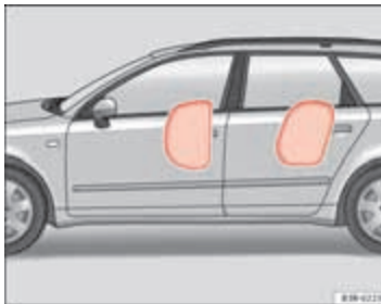
Afbeelding 24 Geactiveerde zijairbag aan de linkerwagzijde
