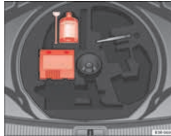
Afbeelding 194 Bandenreparatieset (Tire Mobility System) onder de laadvloer in de bagageruimte
