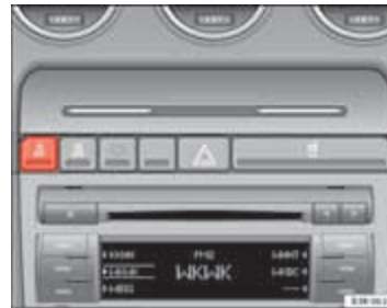
Afbeelding 144 Deel van de middenconsole: ESC-knop
