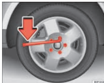
Afbeelding 196 Wiel verwisselen: Wielbouten losdraaien
