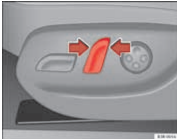
Afbeelding 107 Voorstoel: schakelaar voor de schuine stand van de rugleuning
