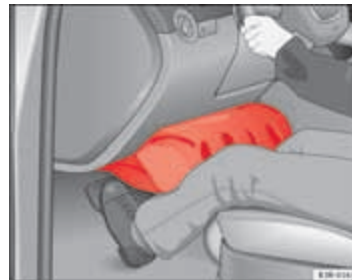
Afbeelding 22 De opgeblazen airbags bieden bescherming bij een frontale botsing.
