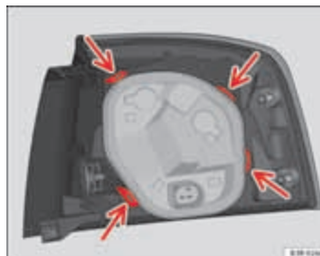
Afbeelding 228 Fittingplaat in achterlicht bevestigen
