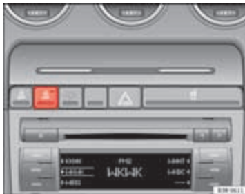
Afbeelding 147 Detail van de drukknop van de Start-Stop functie.
