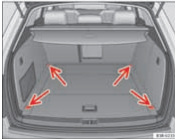
Afbeelding 115 Plaatsing van de bevestigingsogen in de bagageruimte
