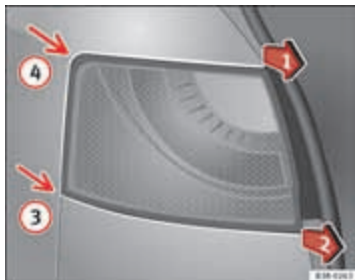
Afbeelding 224 Uitbouwen van achterlicht in zijpaneel
