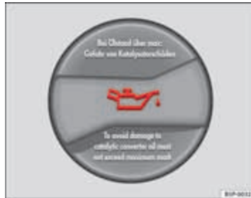
Afbeelding 181 In de motorruimte: dop van de motorolie-vulopening
