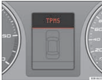
Afbeelding 45 Display: storing van het systeem
