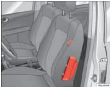
Afbeelding 23 Zijairbag in de bestuurdersstoel
