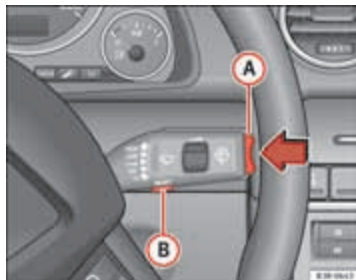
Afbeelding 63 Ruitenwisserhendel: resetknop en tuimelschakelaar
