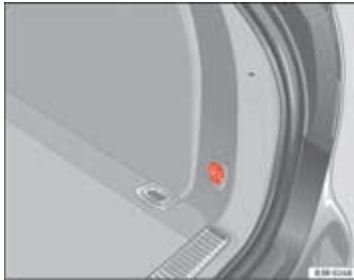
Afbeelding 134 Deel van de zijbekleding van de bagageruimte: 12-volt accessoireaansluiting
