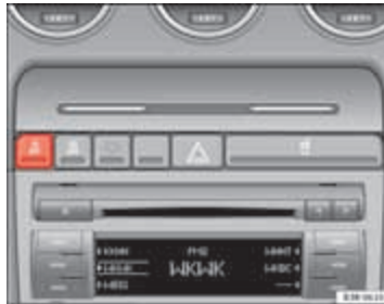
Afbeelding 163 Middenconsole met ESC-schakelaar
