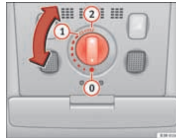
Afbeelding 82 Deel van de hemelbekleding: draaischakelaar voor het schuif-/kanteldak
