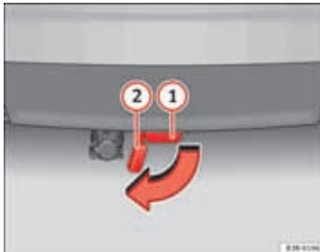
Afbeelding 166 Achterbumper: afsluitdop openklappen
