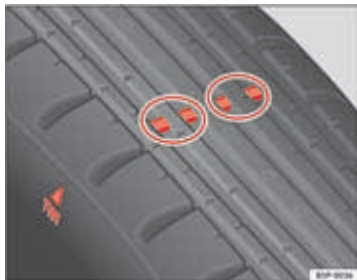
Afbeelding 190 Slijtagemerkttekens van het bandenprofiel
