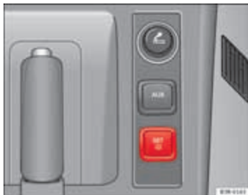
Afbeelding 189 Deel van de middenconsole: Knop voor de bandencontrole
