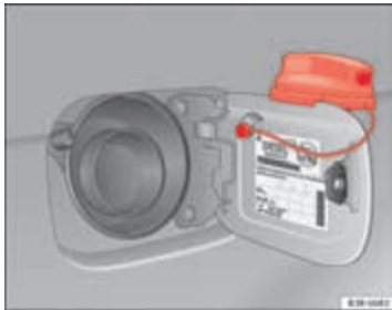
Afbeelding 177 Tankklep met erop geplaatste tankdop
