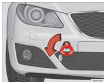
Afbeelding 246 Vastschroeven van het sleepoog aan voorzijde van de wagen
