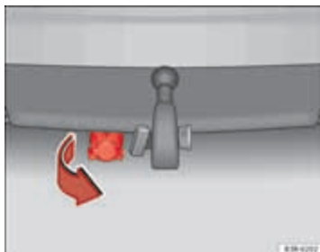
Afbeelding 172 Achterbumper: aanhangwagenstopcontact naar beneden zwenken
