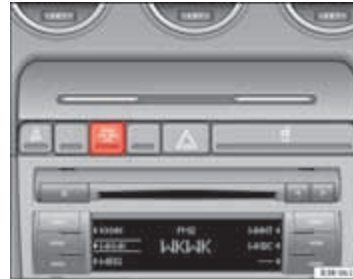
Afbeelding 28 Controlelampje voor buiten werking gestelde bijrijdersairbag
