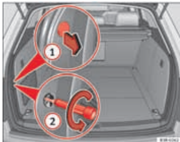
Afbeelding 223 Bagageruimte: Inbouwstand van de bevestigingsbout van het achterlicht
