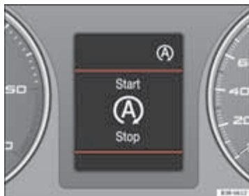
Afbeelding 148 Weergave op het display van het instrumentenpaneel tijdens de Start-Stop werking.
