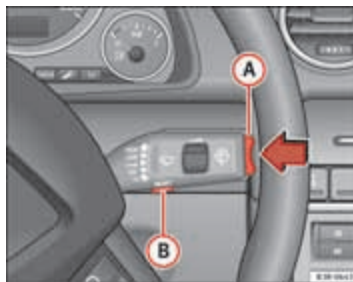
Afbeelding 60 Ruitenswisserhendel: bedieningselementen van de boordcomputer
