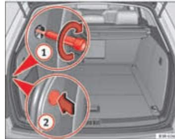
Afbeelding 230 Bagageruimte: Inbouwstand van de bevestigingsbout van het achterlicht
