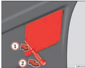
Afbeelding 233 Afdek- king in de achterklepbe- kleding verwijderen
