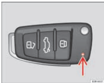
Afbeelding 68 Controlelampje in de sleutel met afstandsbediening
