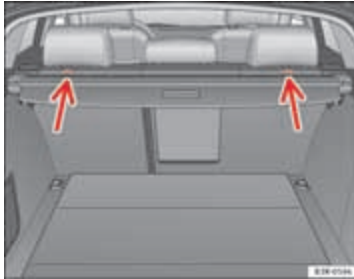
Afbeelding 34 Plaats van de twee Top Tether-ringen op de hoedenplank
