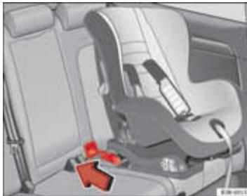
Afbeelding 33 De ISOFIX-verankeringen van het kinderzitje glijden over de reeds ingebouwde kunststofgeleidingen tot deze bevestigd worden aan de ISOFIX-verankeringen van de wagen
