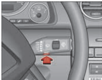
Afbeelding 61 Ruitenwischerhendel: bedieningstoets voor de menukeuze
