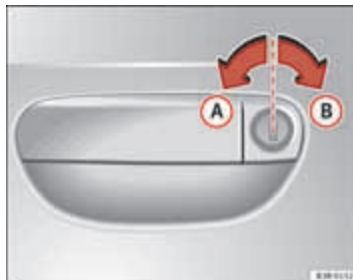
Afbeelding 70 Draairichtingen van de sleutel voor het openen en sluiten
