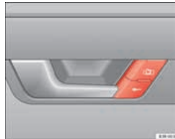
Afbeelding 71 Deel van het bestuurdersportier: Schakelaar centrale vergrendeling
