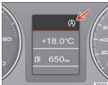
Afbeelding 149 Weergave op het display van het instrumentenpaneel tijdens de Start-Stop werking.
