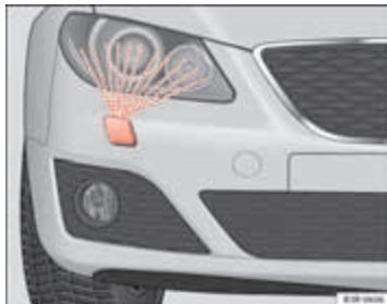
Afbeelding 101 Koplampen met uitgeschoven koplampsproeier
