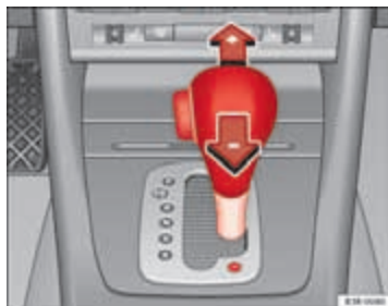
Afbeelding 160 Middenconsole: Handmatig schakelen (tiptronic-functie)
