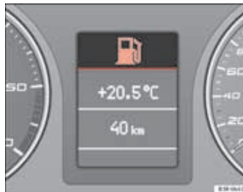
Afbeelding 55 Display: brandstofvoorraad laag ▶
