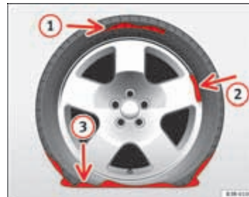
Afbeelding 200 Bandenbeschadiging waarvoor het Tire Mobility System niet geschikt is
