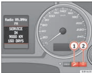
Afbeelding 52 Deel van het instrumentenpaneel: service-interval-indicatie
