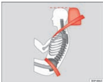
Afbeelding 13 Juist verloop van de gordelband en een juiste stand van de hoofdsteunen van opzij gezien
