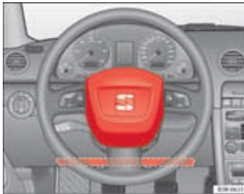
Afbeelding 17 Bestuurdersairbag in het stuurwiel en knieairbag in het dashboard
