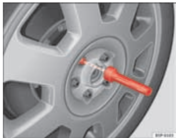
Afb. 127 Wiel verwisselen: Inbusleutel voor het draaien van de bouten
