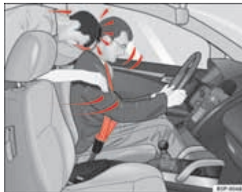
Afb. 9 De niet-vastgespelde passagier op een zitplaats achterin vliegt naar voren op de vastgespelde bestuurder.
