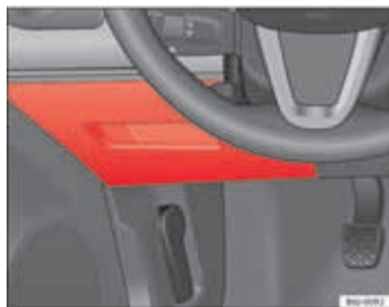
Afb. 129 Zekeringen in het dashboard
