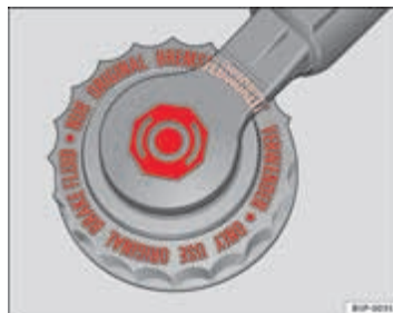
Afb. 122 In de motorruimte: vuldop van het remvloeistofreservoir
