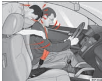
Afb. 9 De niet-vastgegespte passagier op een zitplaats achterin vliegt naar voren op de vastgegespte bestuurder.
