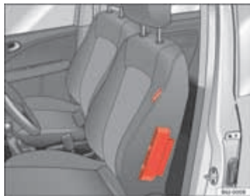
Afb. 19 Zijairbag in de bestuurdersstoel
