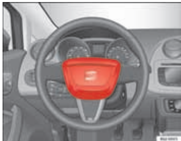
Afb. 16 Inbouwplaats bestuurdersairbag: in het stuurwiel
