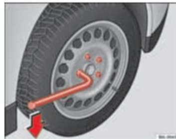
Afb. 126 Wiel verwisselen: de wielbouten losdraaien
