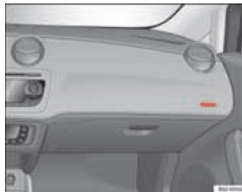
Afb. 17 Inbouwplaats bijrijdersairbag: in het dashboard
