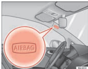
Afb. 21 Inbouwplaats van de hoofdairbag aan de linkerwagzijde
