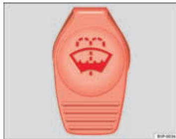
Afb. 119 In de motorruimte: vuldop van het vloeistofreservoir ruitensproeier
