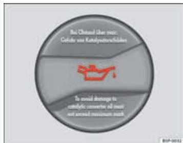
Afb. 117 In de motorruimte: dop van de motorolie-vulopening
