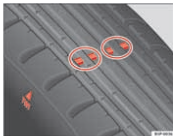
Afb. 123 Slijtagemerken van het bandenprofiel
