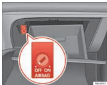
Afb. 23 In het dashboardkastje: sleutelschakelaar voor het in paraatheid brengen en buiten werking stellen van de bijrijdersairbag
