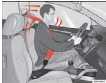
Afb. 10 Bestuurder met de veiligheidsgordel goed om: wordt bij plotseling remmen door de gordel tegengehouden
