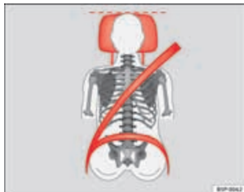
Afbeelding 12 Juist verloop van de gordelband en een juiste stand van de hoofdsteun van voren gezien
