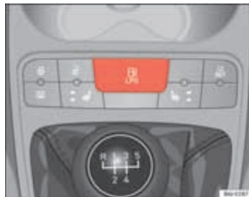
Afbeelding 99 Middenconsole: schakelaar van de gasinstallatie.
