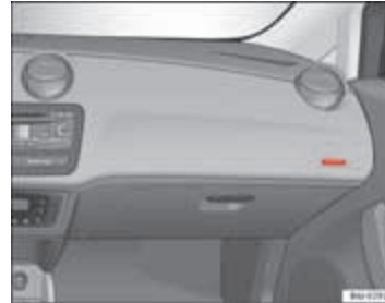
Afbeelding 17 Inbouwplaats bijrijdersairbag: in het dashboard
