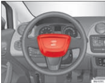
Afbeelding 16 Inbouwplaats bestuurdersairbag: in het stuurwiel
