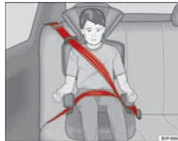
Afbeelding 25 Kinderzitje ingebouwd op de achterbank in de rijrichting.
