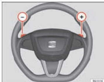
Afbeelding 108 Stuurwiel met hendels voor handmatig schakelen bij automatische versnellingsbak
