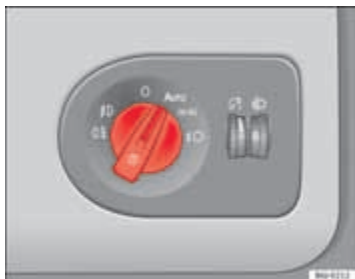
Abbeelding 55 Automatische rijlichtregeling
