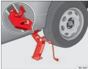
Afbeelding 147 Plaatsen van de krik
