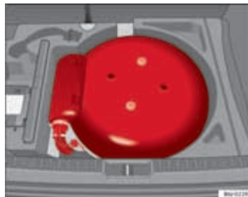
Afbeelding 129 LPG-tank in uitsparing voor reservewiel.
