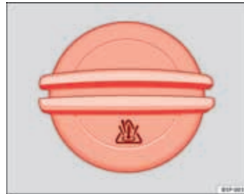
Abbeelding 135 In de motorruimte: vuldop van het koelvloeistofexpansiereservoir
