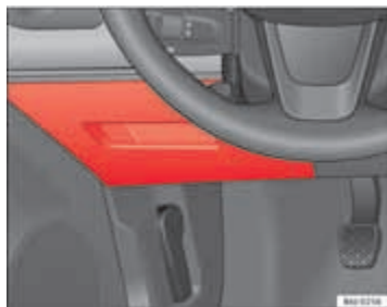
Afbeelding 149 Zekeringen in het dashboard
