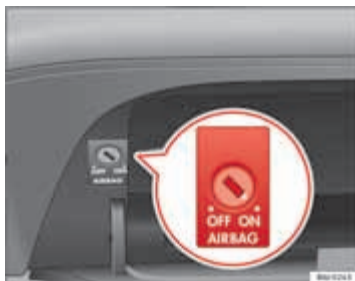
Afbeelding 21 In het dashboardkastje: sleutelschakelaar voor het in- en uitschakelen van de bijrijdersairbag
