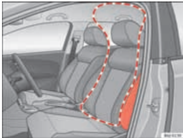
Afbeelding 20 Zijairbag in de bestuurdersstoel
