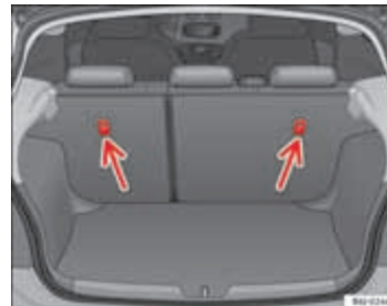
Afbeelding 27 Stand van de Top Tether-ringen aan de achterzijde van de achterbank
