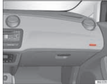
Afbeelding 17 Inbouwplaats bijrijdersairbag: in het dashboard
