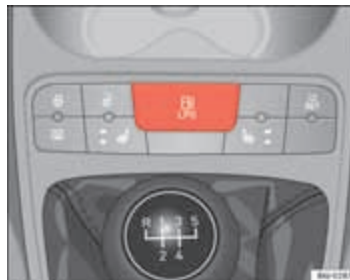
Afbeelding 100 Middenconsole: schakelaar van de gasinstallatie.
