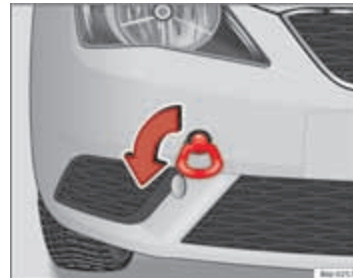
Afbeelding 170 Vast Schroeven van het sleepoog aan de voorzijde van de wagen
