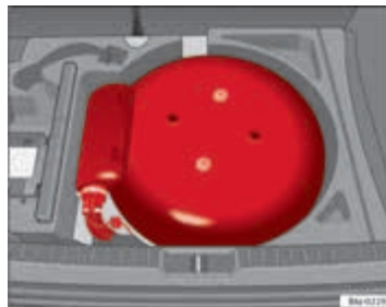
Afbeelding 132 LPG-tank in uitsparing voor reservewiel.
