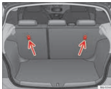
Abbeelding 27 Stand van de Top Tether-ringen aan de achterzijde van de achterbank
