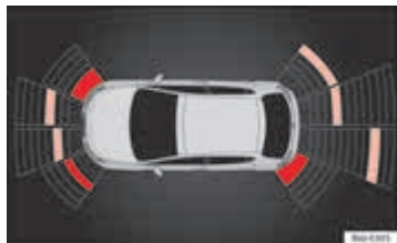
Afbeelding 124 Weergave van de parkeerhulp op het display van het navigatiesysteem.
