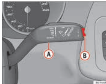
Afbeelding 35 Ruitensproeier- en -wischerhendel: toets A en tuimelschakelaar B
