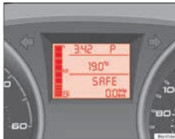
Afbeelding 36 Display: Stand van de keuzehandel van automatische versnellingsbak
