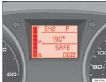
Afbeelding 117 Automatische versnellingsbak: Display van het instrumentenpaneel
