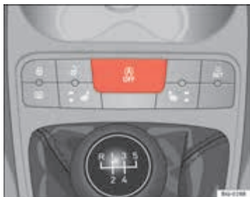
Afbeelding 112 Detail van de drukknop van de Start-Stop functie.
