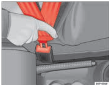
Afbeelding 11 Gordelslot en slotgesp van de veiligheidsgordel
