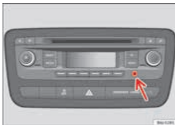
Afbeelding 92 AUX-aansluiting op de middenconsole (afhankelijk van de uitrusting)
