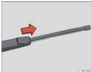
Afbeelding 142 Wisserblad van de achterruit verwijderen
