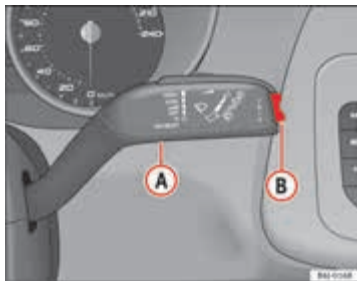
Afbeelding 34 Ruitenwischerhendel: toets A en tuimelschakelaar B
