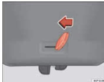
Afbeelding 50 IBIZA / IBIZA SC: Noodontgrendeling van achterklep
