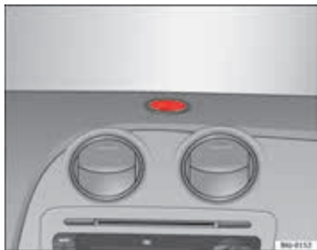
Afbeelding 82 Steun voor navigatiesysteem op instrumentenpaneel.
