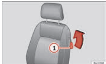
Afbeelding 75 Voorstoelen: hendel om de leuning neer te klappen
