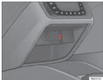
Afbeelding 93 AUX-USB-aansluiting (afhankelijk van de uitrusting)
