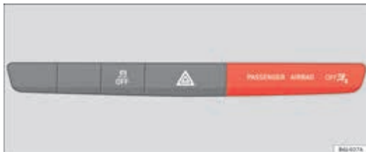
Afbeelding 22 Controlelampje voor buiten werking gestelde bijrijdersairbag
