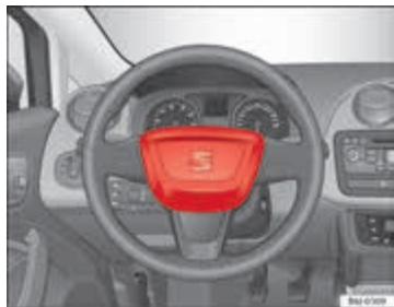
Afbeelding 16 Inbouwplaats bestuurdersairbag: in het stuurwiel
