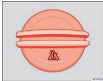
Afbeelding 138 In de motorruimte: vuldop van het koelvloeistofexpansiereservoir
