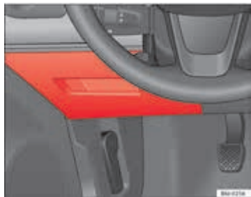
Afbeelding 152 Links in het dashboard: deksel van de zekeringhouder.
