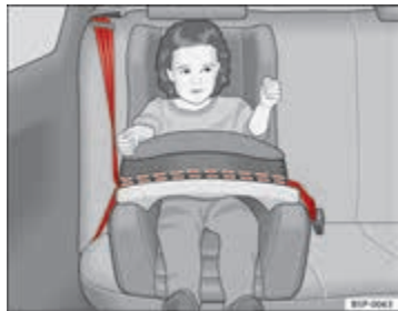
Afbeelding 24 In rijrichting geplaatst kinderzitje voor groep 1 op de achterbank.
