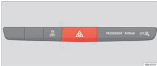
Abbeelding 61 Dashboard: schakelaar voor alarmlichten
