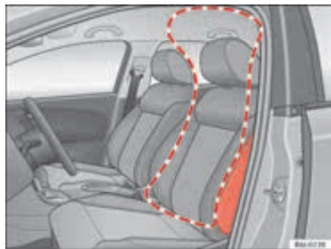
Afbeelding 20 Zijairbag in de bestuurdersstoel
