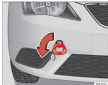
Afbeelding 190 Vast-schroeven van het sleepoog aan de voorzijde van de wagen
