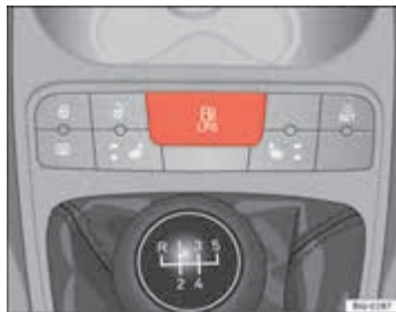
Afbeelding 111 Middenconsole: schakelaar van de gasinstallatie.
