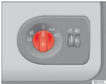
Afbeelding 56 Deel van het dashboard: lichtschakelaar, mistlampen en mistachterlicht
