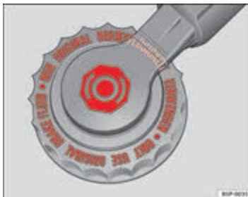
Afbeelding 144 In de motorruimte: vuldop van het remvloeistofreservoir ►
