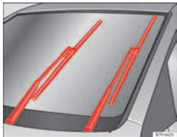
Afbeelding 140 Ruitenwischer in servicestand
