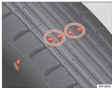
Afbeelding 145 Slijtagemerkttekens van het bandenprofiel
