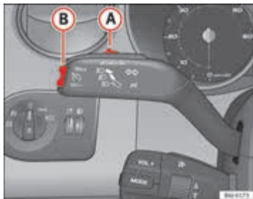
Afbeelding 126 Knipperlicht- en grootlichthendel: schakelaar en tuimelschakelaar voor het snelheidsregelsysteem
