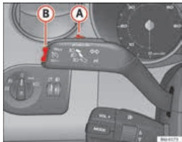
Afbeelding 127 Knipperlicht- en grootlichthendel: schakelaar en tuimelschakelaar voor het snelheidsregelsysteem
