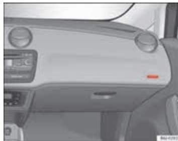
Afbeelding 17 Inbouwplaats bijrijdersairbag: in het dashboard
