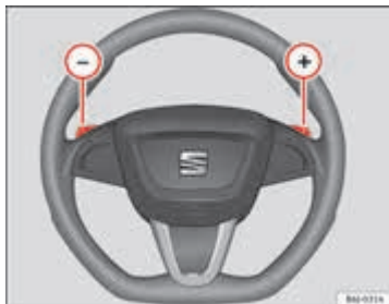
Afbeelding 120 Stuurwiel met hendels voor handmatig schakelen bij automatische versnellingsbak
