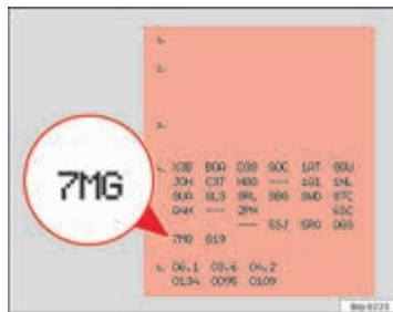
Afbeelding 128 Sticker met wagengegevens op de binnenzijde van de omslag van het Onderhoudsprogramma
