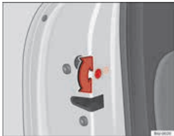
Afbeelding 44 Kinderslot in het linkerporthier
