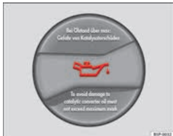
Afbeelding 137 In de motorruimte: dop van de motorolie-vulopening
