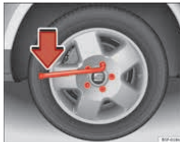
Afbeelding 148 Wiel verwisselen: de wielbouten losdraaien
