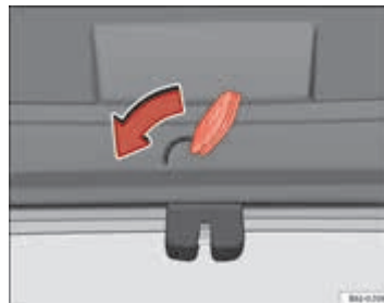
Afbeelding 51 IBIZA ST: Noodontgrendeling van achterklep
