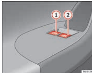
Afbeelding 53 Deel van het bestuurdersportier: knoppen voor de voorste ruiten (3-deurs wagen)
