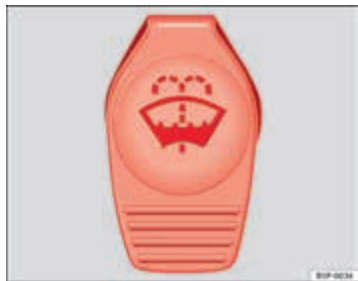
Afbeelding 139 In de motorruimte: vuldop van het vloeistofreservoir ruitensproeier
