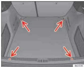
Afbeelding 97 Plaatsing van de bevestigingsogen in de bagageruimte
