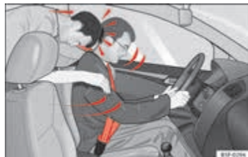
Afbeelding 53 De niet-vastgespelde passagier op een zitplaats achterin vliegt naar voren op de vastgespelde bestuurder.
