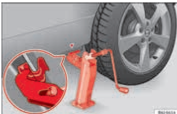
Afbeelding 161 Plaatsen van de krik.
