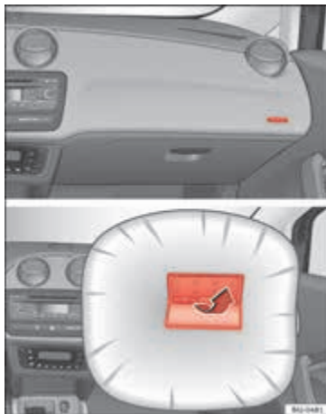
Afbeelding 57 Bijrijdersairbag in het dashboard.
