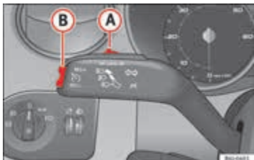
Afbeelding 149 Knipperlicht- en grootlichthendel: schakelaar en tuimelschakelaar voor het snelheidsregelsysteem.
