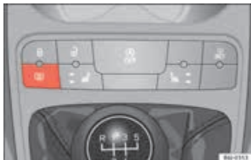
Afbeelding 94 Middenconsole: schakelaar achterrautverwarming.
