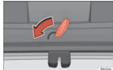
Afbeelding 168 IBIZA ST: Noodontgrendeling van achterklep.
