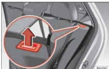
Afbeelding 102 Ontgrendelknop van de leuning van de achterbank.
