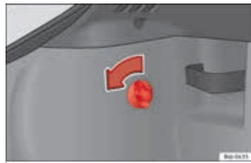
Afbeelding 195 Toegang tot de achterlampjes.
