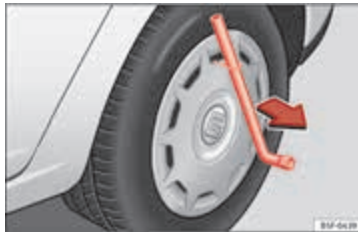
Afbeelding 158 Grote wioldop verwijderen.
