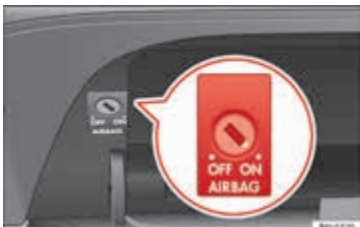
Afbeelding 61 In het dashboardkastje: sleutelschakelaar voor het in- en uitschakelen van de bijrijdersairbag.
