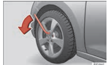
Afbeelding 159 Wiel verwisselen: de wielbouten losdraaien.
