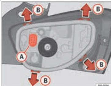
Afbeelding 196 Vervanging lampjes achterlichten.
