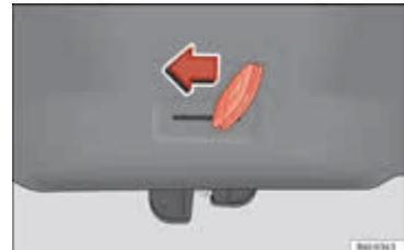
Afbeelding 167 IBIZA / IBIZA SC: Noodontgrendeling van achterklep.
