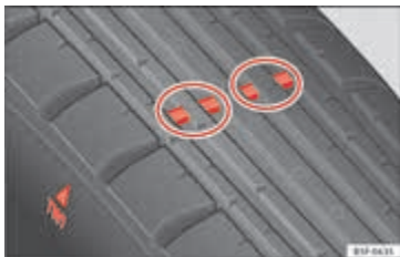
Afbeelding 154 Slijtagemerkttekens van het bandenprofiel.
