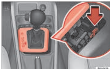
Afbeelding 169 Noodontgrendelen van de keuzehendel.
