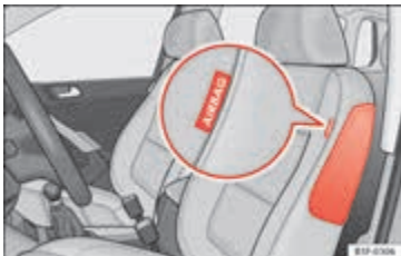
Abbeelding 58 Zij-airbag in de bestuurdersstoel.
