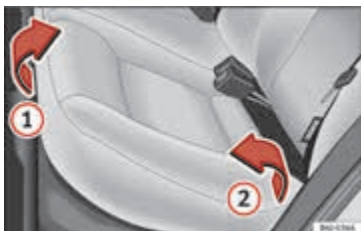
Afbeelding 101 Zitting van de achterbank omhoogklappen.
