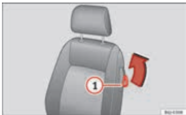
Afbeelding 98 Voorstoelen: hendel om de leuning neer te klappen.
