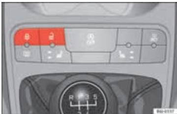
Afbeelding 81 Drukknop voor centrale vergrendeling.
