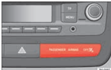
Afbeelding 62 Centraal deel van het dashboard: controlelampje voor buiten werking gestelde bijrijdersairbag.
