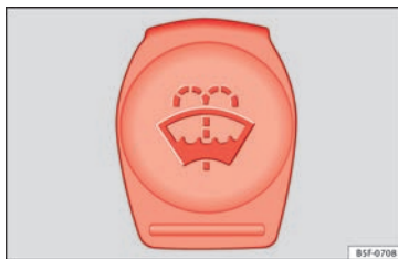
Afb. 55 In de motorruimte: dop van het ruitensproeiervloeistofreservoir.
