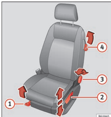
Afb. 10 Voorstoelen: handmatig verstellen van de stoel.
