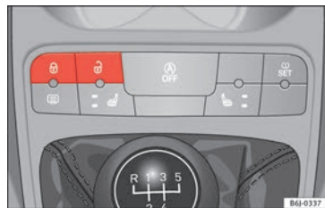
Afb. 119 Drukknoop voor centrale vergrendeling.
