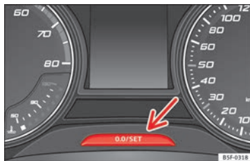
Afb. 114 Instrumentenpaneel: kilometerteller en resetknop.
