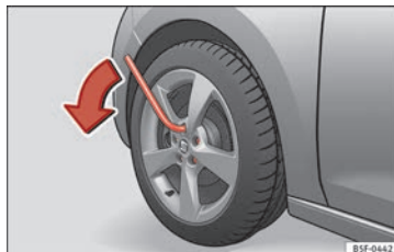
Afb. 64 Wiel: de wielbouten losdraaien.
