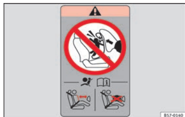
Afb. 23 In de achterste omlijsting van het bijrijdersportier: sticker over de airbag.
