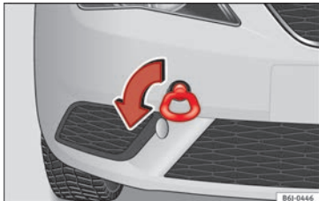
Afb. 67 Voorbumper rechts: sleepoog.
