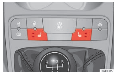
Afb. 134 Schakelaar voor stoelverwarming voorstoelen.
