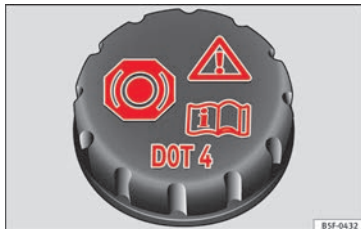
Afb. 54 Motorruimte: dop van het remvloeistofreservoir.
