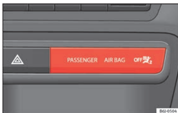
Afb. 43 Controlelampje voor het buiten werkings stellen van de bijrijdersairbag.
