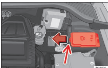
Afb. 57 In de motorruimte: deksel van de zekeringenhouder.
