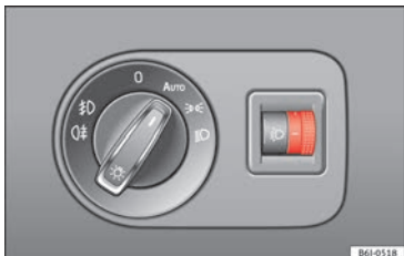
Afb. 127 Dashboard: lichtbundel-hoogteverstelling van de koplampen.
