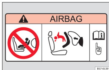
Afb. 22 Zonneklep aan de bijrijderszijde: sticker van de airbag.
