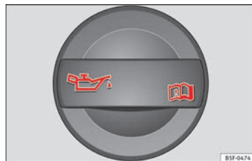
Afb. 52 In de motorruimte: dop van de motorolie-vulopening.
