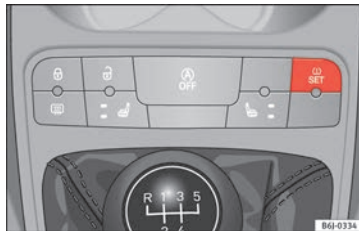
Afb. 179 Middenconsole: toets van het controlesysteem van de banden.
