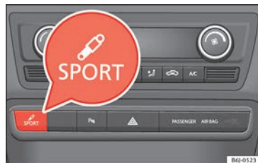
Afb. 171 In de middenconsole: toets om het systeem "SEAT Drive Profile" af te stellen
