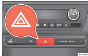
Afb. 31 Dashboard: schakelaar voor alarmlichten.
