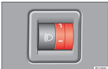
Afb. 150 Dashboard: lichtbundel-hoogteverstelling van de koplampen.
