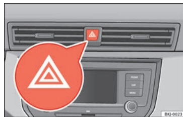
Afb. 42 Dashboard: schakelaar voor alarmlichten.
