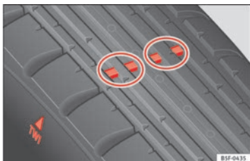
Afb. 232 Slijtagemerktekens van het bandenprofiel.
