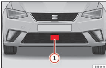
Afb. 192 Op de voorbumper: radarsensor.
