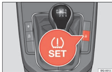
Afb. 234 Middenconsole: toets van het controlesysteem van de banden.
