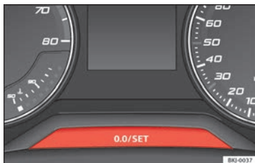
Afb. 126 Instrumentenpaneel: kilometerteller en resetknop.
