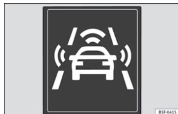
Afb. 191 Op het display van het instrumentenpaneel: voorwaarschuwingsaanwijzingen.
