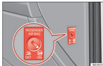
Afb. 105 Sleutelschakelaar voor het in- en uitschakelen van de bijrijdersairbag.
