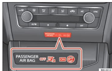
Afb. 106 Centraal deel van het dashboard: controlelampje voor buiten werking gestelde bijrijdersairbag.
