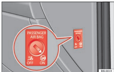
Afb. 23 Schakelaar voorairbag aan bijrijderszijde.
