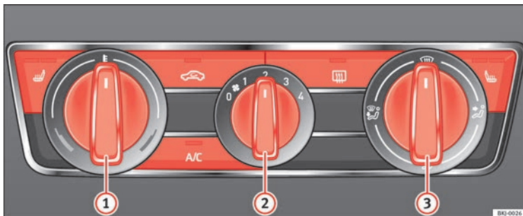
Afb. 63 In de middenconsole: knoppen voor de handbediende airconditioning.
