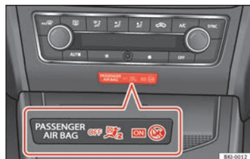
Afb. 57 Controlelampje voor het buitenwerk- ing stellen van de bijrijdersairbag.
