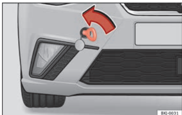
Afb. 109 Voorbumper rechts: vastgeschroefd sleepoog.
