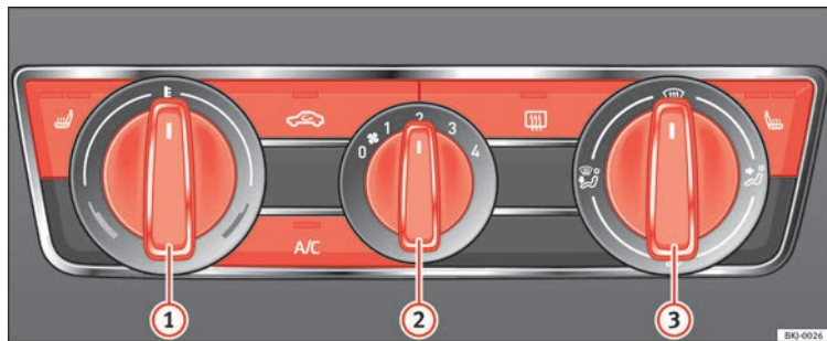
Afb. 175 Bedieningselementen van de airconditioning op het dashboard.
