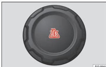
Afb. 68 Motorruimte: vuldop van het koel-vloeistofexpansiereservoir.
