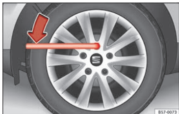
Afb. 83 Wiel verwisselen: de wielbouten losdraaien.
