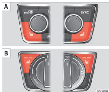
Afb. 156 In de middenconsole: schakelaars voor stoelverwarming voor de voorstoelen. A: versie met Climatronicon. B: versie met handbediende airconditioning.
