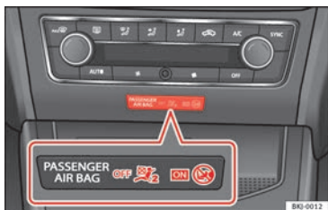
Afb. 24 Centraal deel van het dashboard: controlelampje voor buiten werking gestelde bijrijdersairbag.
