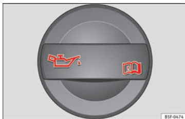
Afb. 67 In de motorruimte: dop van de motorolie-vulopening.
