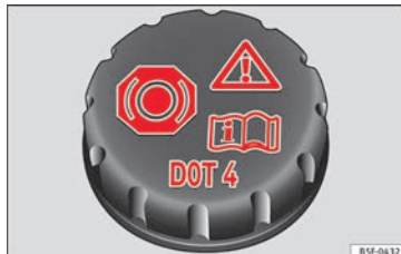
Afb. 69 Motorruimte: dop van het remvloeistofreservoir.
