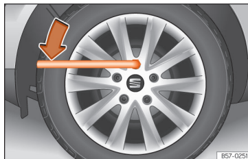
Afb. 74 Wiel verwisselen: wielbouten losdraaien.
