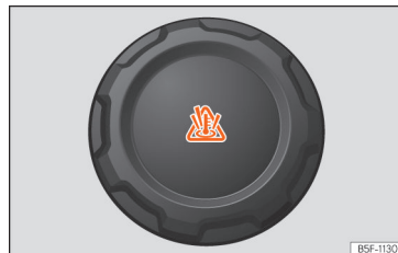
Afb. 61 Motorruimte: vuldop van het koelvloeistofexpansiereservoir.
