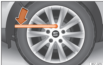
Afb. 38 Wiel verwisselen: wielbouten losdraaien.
