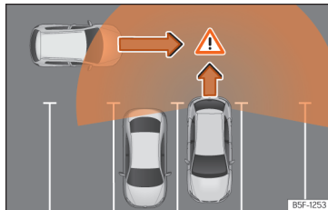
Afb. 164 Schematische weergave van de uitparkeerhulp: bewaakte zone rond de wagen die aan het uitparkeren is.
