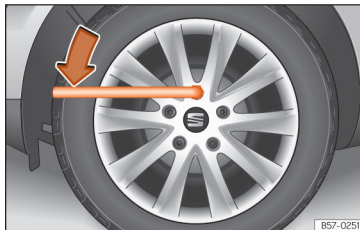
Afb. 36 Wiel verwisselen: wielbouten losdraaien.
