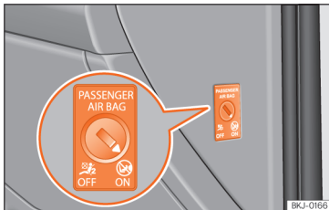
Afb. 16 Sleutelschakelaar voor het in- en uitschakelen van de bijrijdersairbag.
