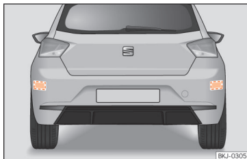
Afb. 145 Achteraanzicht van de wagen: zones van de radarsensor.
