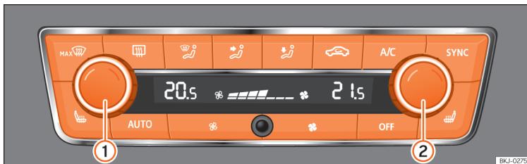
Afb. 122 In de middenconsole: bedieningselementen van de Climatronic.
