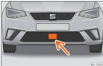
Afb. 142 In de voorbumper: radarsensor.
