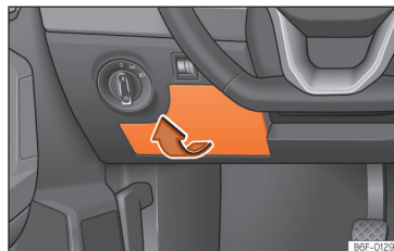
Afb. 49 In het dashboard aan bestuurderszijde: afdekking van de zekeringenhouder.
