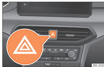
Afb. 98 Dashboard: schakelaar voor alarmlichten.
