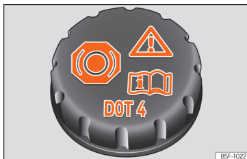
Afb. 194 Motorruimte: dop van het remvloeistofreservoir.
