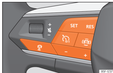
Afb. 152 Op het multifunctiestuurwiel: knoppen voor bediening van ACC
