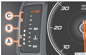
Afb. 70 Digitaal instrumentenpaneel: koelvloeistoftemperatuurmeter.
