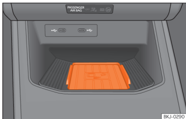
Afb. 130 In de middenconsole: steun voor het aansluiten van de mobiele telefoon.
