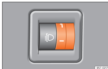
Afb. 99 Naast het stuur: lichtbundelhoogteverstelling
