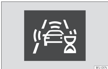
Afb. 151 Op het display van het instrumentenpaneel: aanwijzing van initiële zelfkalibratie van het systeem.
