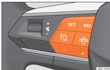
Afb. 149 Op het multifunctiestuurwiel: knoppen voor bediening van de snelheidsbegrenzer
