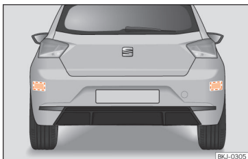
Afb. 100 Achteraanzicht van de wagen: zones van de radarsensoren.
