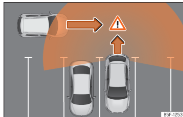
Afb. 124 Schematische voorstelling van de uitparkeerhulp: bewaakt gebied rond de wagen die een parkeerplaats verlaat
