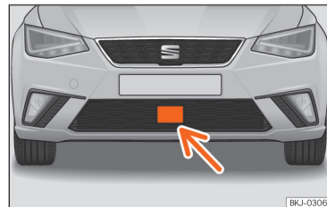
Afb. 97 In de voorbumper: radarsensor.
