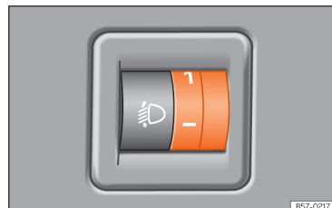
Afb. 75 Naast het stuur: lichtbundelhoogteverstelling.
