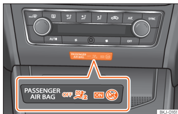
Afb. 31 In het middelste deel van het instrumentenpaneel: controlelampje van buiten werking stellen van de bijrijdersairbags.
