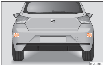
Afb. 99 Achteraanzicht van de wagen: zones van de radarsensoren.
