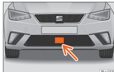
Afb. 96 In de voorbumper: radarsensor.
