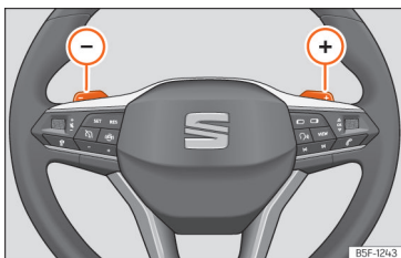
Afb. 91 Stuur: hendels voor automatisch schakelen.
