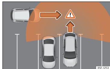
Afb. 123 Schematische voorstelling van de uitparkeerhulp: bewaakt gebied rond de wagen die een parkeerplaats verlaat
