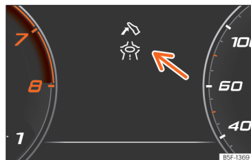
Afb. 11 Aanwijzing van het hulpsysteem voor eco-efficiënt rijden (schematische voorstelling).
