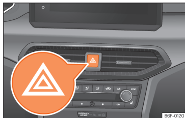
Afb. 43 Dashboard: schakelaar voor alarmlichten.
