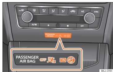
Afb. 30 In het middelste deel van het instrumentenpaneel: controlelampje van buiten werking stellen van de bijrijdersairbags.
