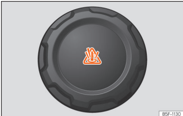
Afb. 171 Voorruimte: vuldop van het koelvloeistofexpansiereservoir.
