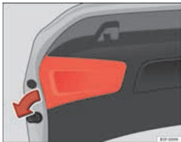
Afbeelding 146 Afdekking in de achterklep verwijderen
