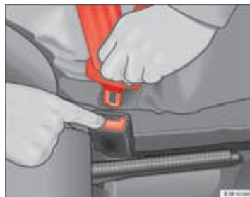
Afbeelding 15 Slotgesp uit het gordelslot losmaken
