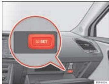
Afbeelding 102 Dashboardkastje: schakelaar voor het bandenspanningscontrolesysteem
