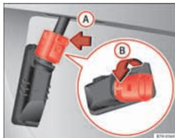
Afbeelding 150 kentekenverlichting: fitting uitbouwen
