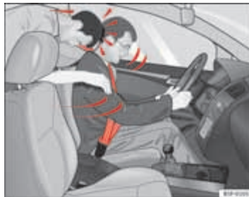
Afbeelding 9 De niet-vastgespelde passagier op een zitplaats achterin vliegt naar voren op de vastgespelde bestuurder.
