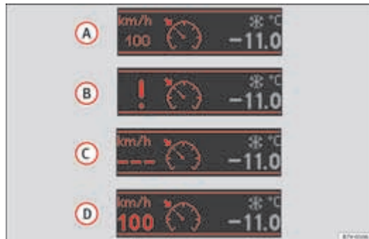
Abbeelding 94 Display in het instrumentenpaneel: statusaanduidingen van GRA. ▶
