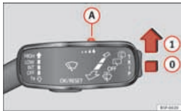
Afbeelding 66 Ruitenwischerhendel: regensensor ① afstellen.
