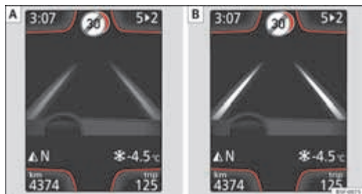
Afbeelding 97 Op het display van het instrumentenpaneel: Indicatie op het display van de rijstrookassistent (voorbeeld 1)
