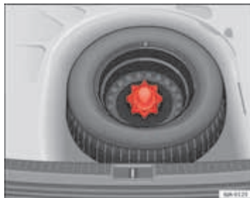
Afbeelding 125 Noodreservewiel: opgeklapte laadvloer
