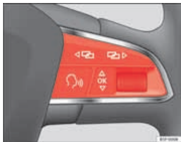
Afbeelding 41 Rechterdeel van het multifunctiestuurwiel: toetsen om de menu's van het instrumentenpaneel te gebruiken.
