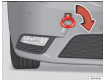
Afbeelding 128 Voorbumper rechts: Vastgeschroefd sleepoog
