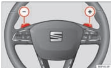
Afbeelding 92 Stuurwiel: hendels voor handmatig schakelen bij een automatische transmissie
