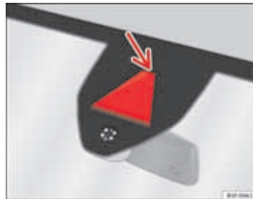
Afbeelding 99 In de voorruit: Zichtveld van de camera van de rijstrookassistent
