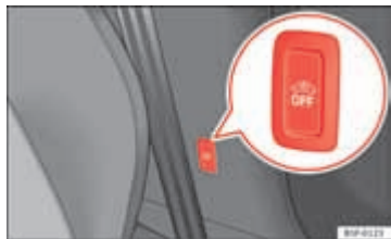
Afbeelding 51 Toets voor interieurbewaking/afsleepalarm
