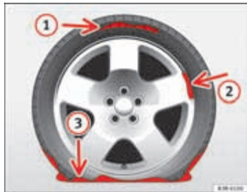
Afbeelding 117 Band: niet te repareren schade
