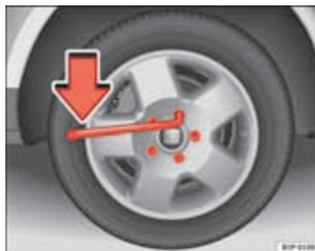
Afbeelding 122 Wiel: de wielbouten losdraaien
