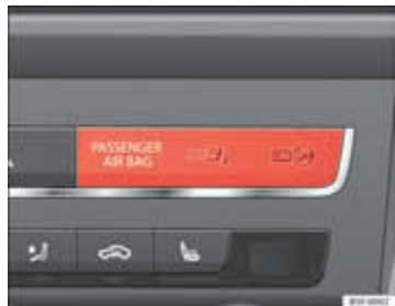
Afbeelding 16 Controlelampje in het dashboard voor de uitschakeling van de voorairbag van de bijrijder.
