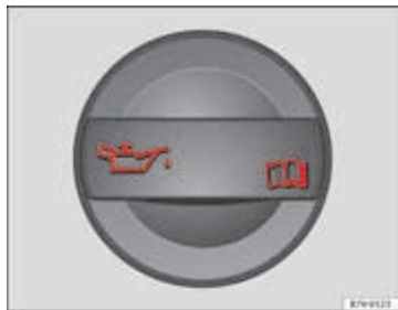
Afbeelding 109 In het motorcompartiment: dop van de motorolie-vulopening
