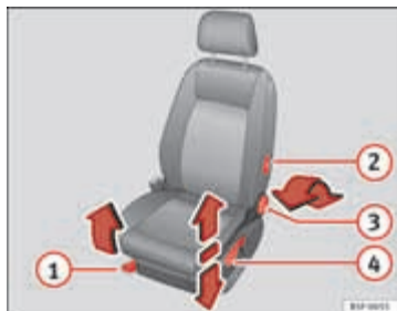
Afbeelding 71 Voorstoelen: handmatig verstellen van de stoel
