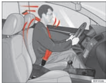
Afbeelding 10 Bestuurder met de veiligheidsgordel goed om: wordt bij plotseling remmen door de gordel tegengehouden
