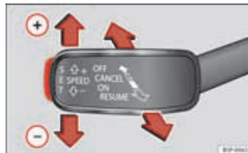
Afbeelding 96 Links van de stuurkolom: derde keuzehendel met 6 standen voor bediening van de GRA.
