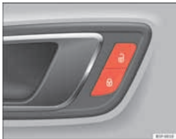
Afbeelding 50 Bestuurdersportier: knop centrale vergrendeling
