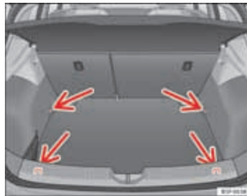
Afbeelding 80 Plaatsing van de bevestigingsogen in de bagageruimte
