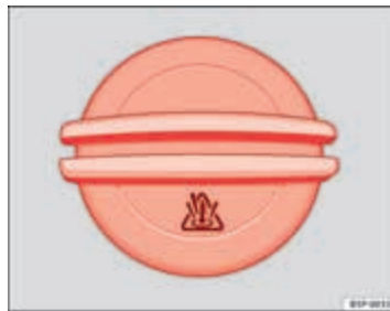
Afbeelding 110 Motorcompartment: Vuldop van het koelvloeistofexpansiereservoir
