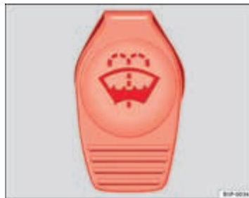
Afbeelding 68 In het motorcompartiment: dop van het ruitensproeiervloestofreservoir.
