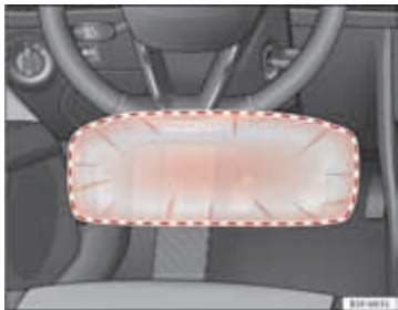
Afbeelding 22 Aan de bestuurderszijde: Werkinggebied van de airbag voor de knieën.
