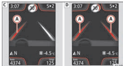
Afbeelding 98 Op het display van het instrumentenpaneel: Indicatie op het display van de rijstrookassistent (voorbeeld 2)
