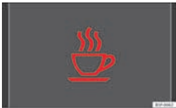
Afbeelding 101 Op het display van het instrumentenpaneel: symbool voor detectie van vermoeidheid.
