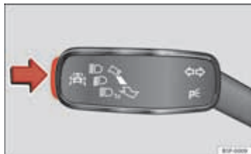
Afbeelding 42 In de knipperlicht- en grootlichthendel: toets voor de systemen ter ondersteuning van de bestuurder.
