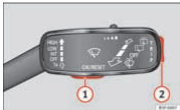
Afbeelding 40 In wagens zonder multifunctiestuurwiel: Toets ① in de ruitenwisserhendel voor het bevestigen van de opties in het menu en tuimelaarschakelaar ② voor het wisselen van menu.
