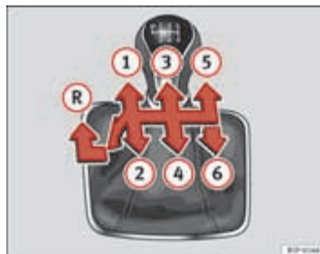
Afbeelding 89 Schema van een handmatige versnelling met 5 of 6 standen.
