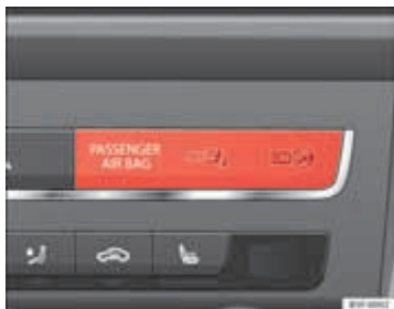
Afbeelding 27 Controlelampje van het buiten werking stellen van de bijrijdersairbag
