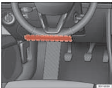
Afbeelding 21 Aan de bestuurderszijde: plaats van de airbag voor de knieën.
