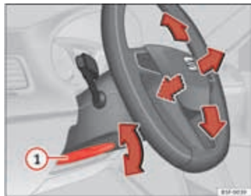
Afbeelding 85 Hendel links onder aan de stuurkolom
