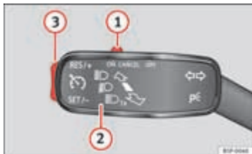
Afbeelding 95 Links van de stuurkolom: bedieningsschakelaar en -elementen van de GRA.
