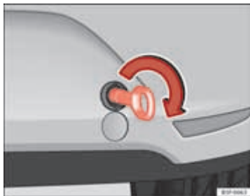
Afbeelding 130 Achterbumper rechts: Vastgeschroefd sleepoog
