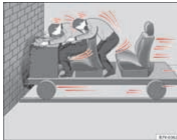
Afbeelding 7 De wagen botst tegen de muur: de inzittenden hebben de veiligheidsgordel niet om
