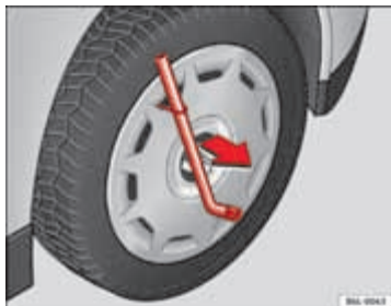
Afbeelding 119 De grote wioldoppen verwijderen
