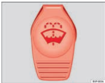
Afbeelding 112 Motorcompartiment: Dop van het ruitensproeiervloeistofreservoir
