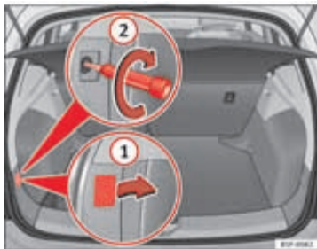
Afbeelding 143 Bagageruimte: Inbouwstand van de bevestigingsbout van het achterlicht
