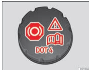
Afbeelding 111 Motorcompartiment: dop van het remvloeistofreservoir
